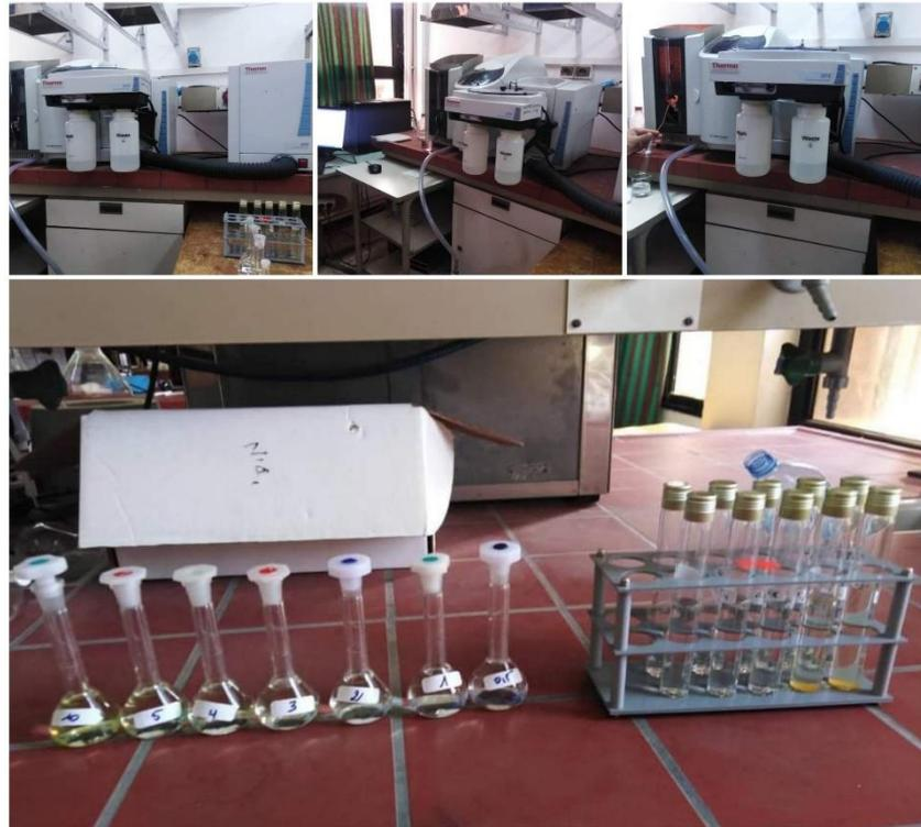
**Figure III.11.** : La spectrométrie d'absorption atomique (SAA).
