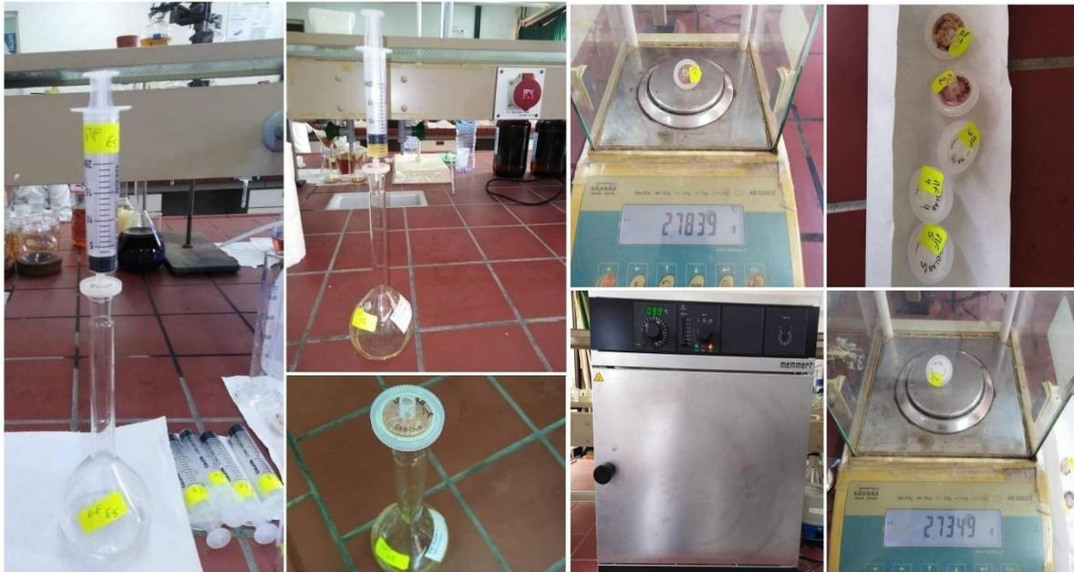
Figure III.10. : La mesure des matières en suspension.
