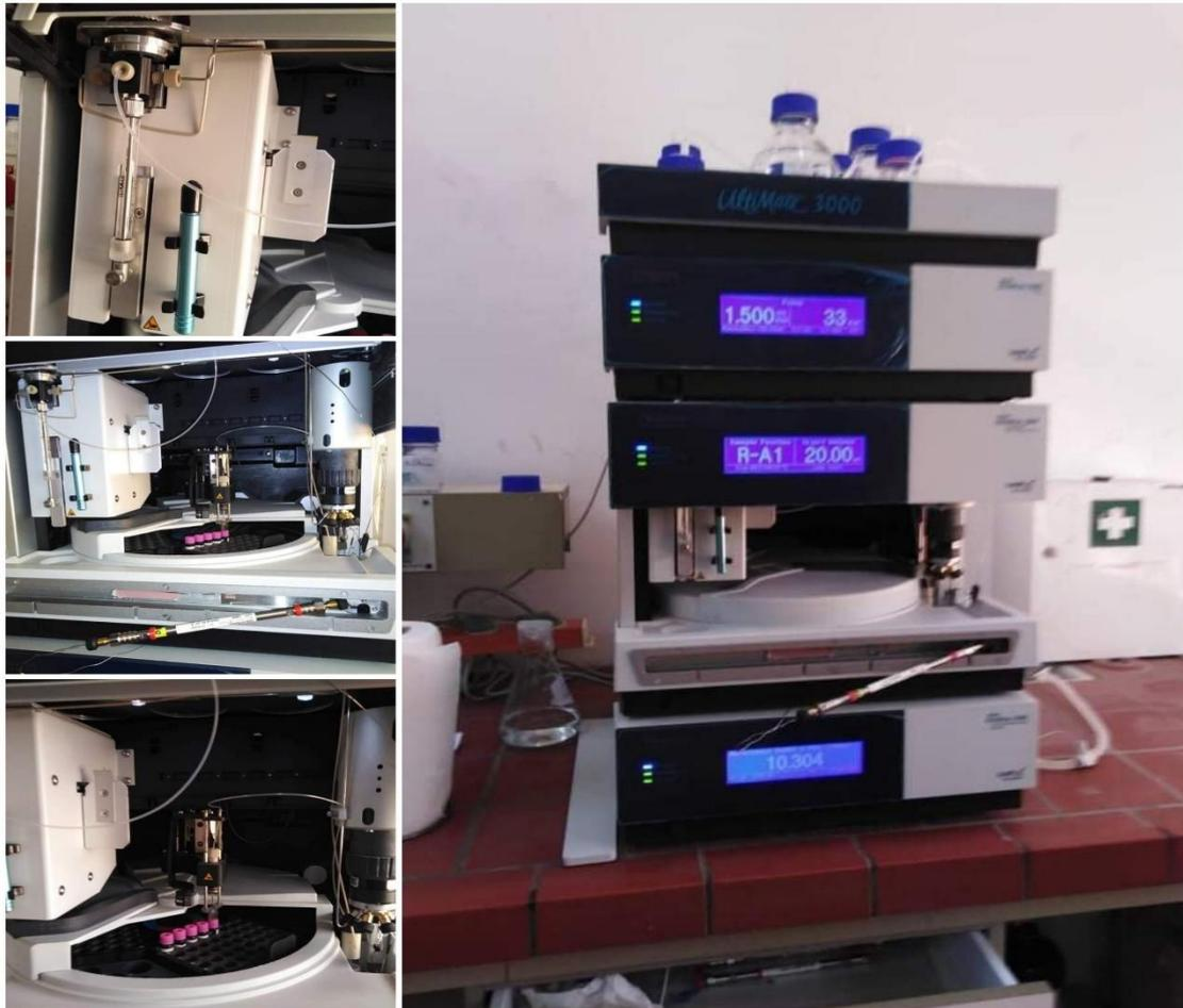
**Figure III.17.** : L'appareil de la chromatographie liquide à haute performance durant l'exécution de l'analyse.
