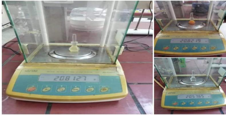
**Figure III.5.** : la méthode de mesure de la densité avec pycnomètre.
