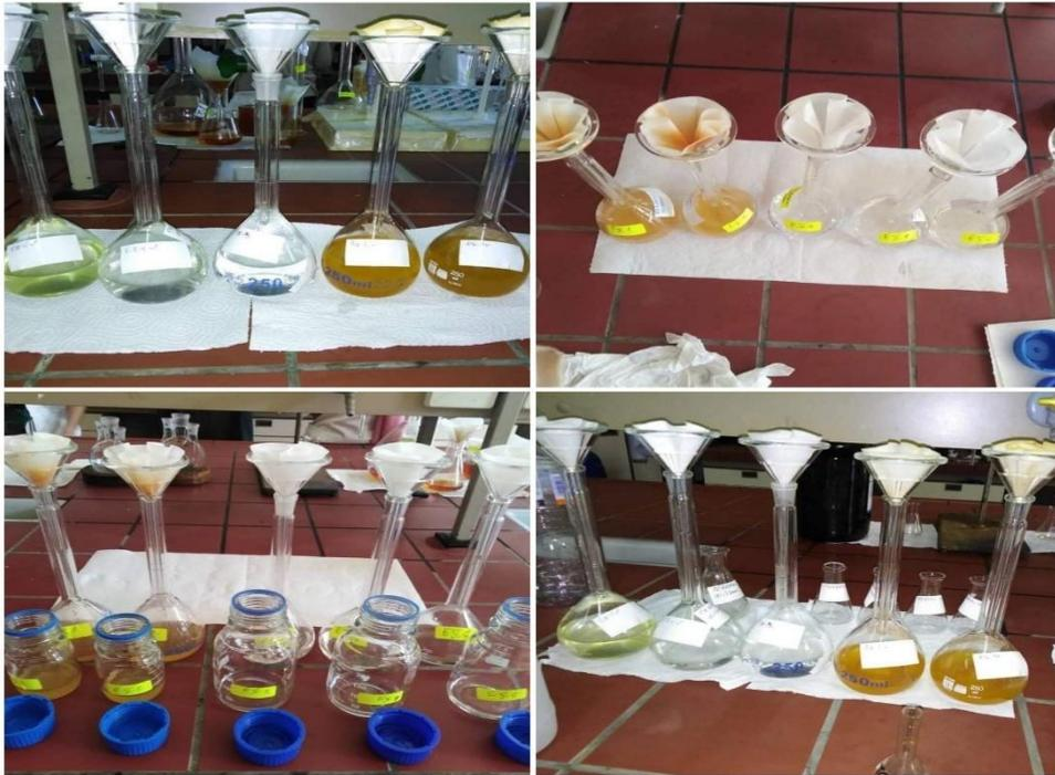
Figure III.7. : La filtration avec du papier filtre.
