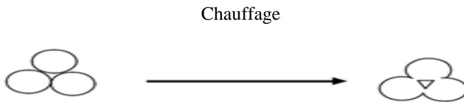
**Figure I.5.** Schéma illustrant le processus d'agglomération
