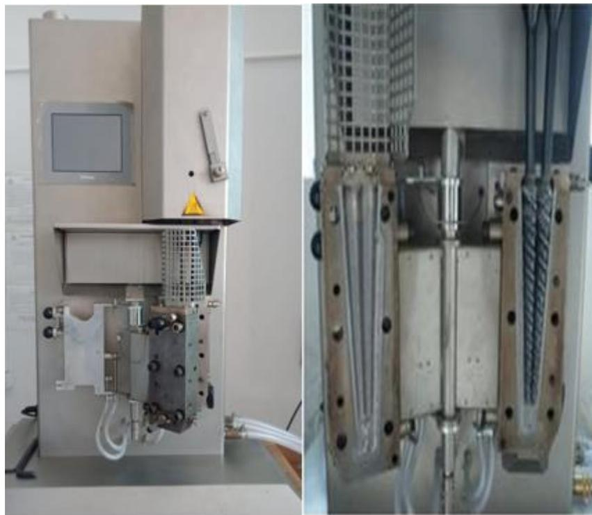
Figure IV.3.Extrudeuse bi-vis.
