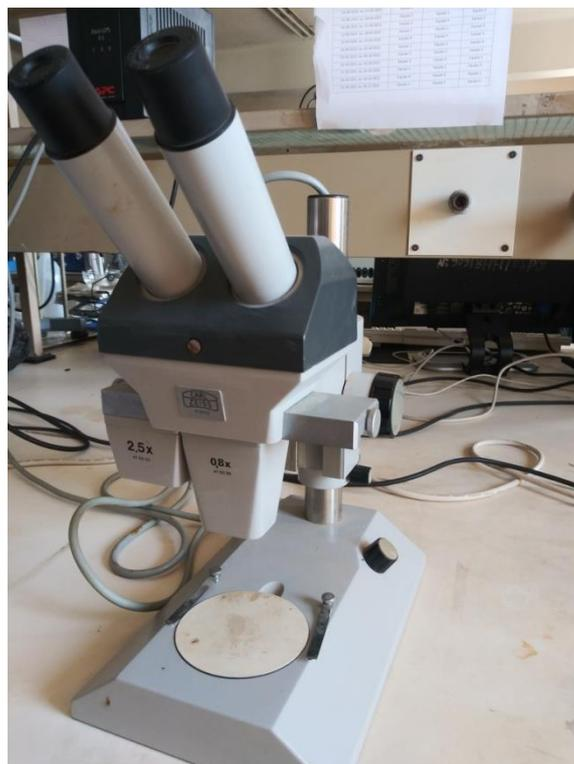
**Figure.II.15.** Microscope Optique de type CARL ZEISS 475039.
