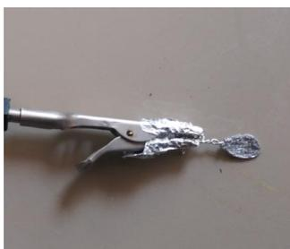
**Figure.II.4.** Image de la contre électrode.
