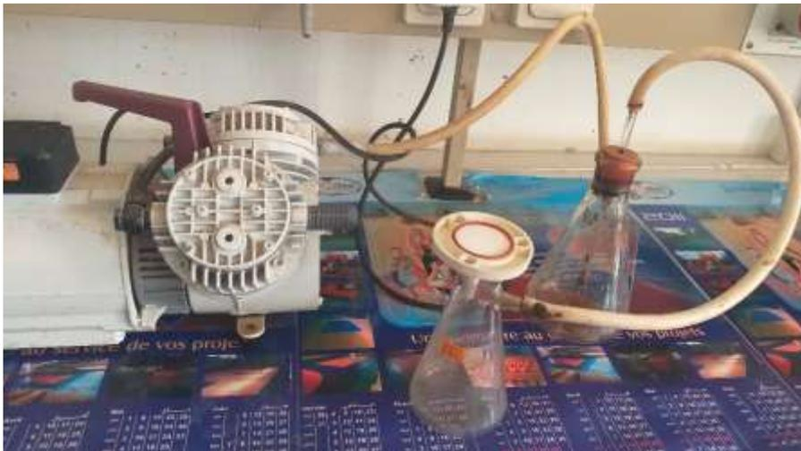
**Figure B.8. Filtration sous vide d'une eau CCP**
