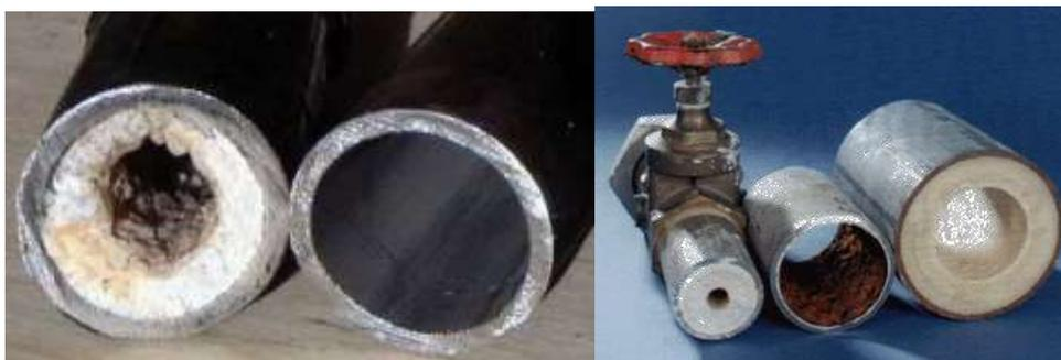
**Figure A.II.1 : Photos des dépôts de tartre de carbonate de calcium dans la canalisation**
