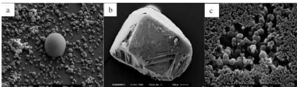
**Figure A.II.3** (a) photo MEB du carbonate de calcium amorphe. (b) photo MEB du carbonate de calcium monohydraté. (c) photo MEB du carbonate de calcium hexahydraté
