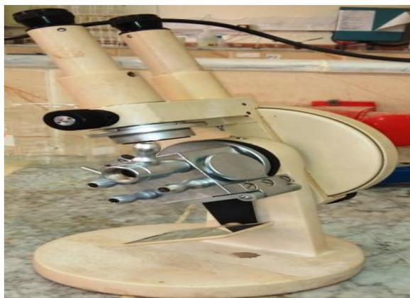
**Figure 14 :** Réfractomètre.
