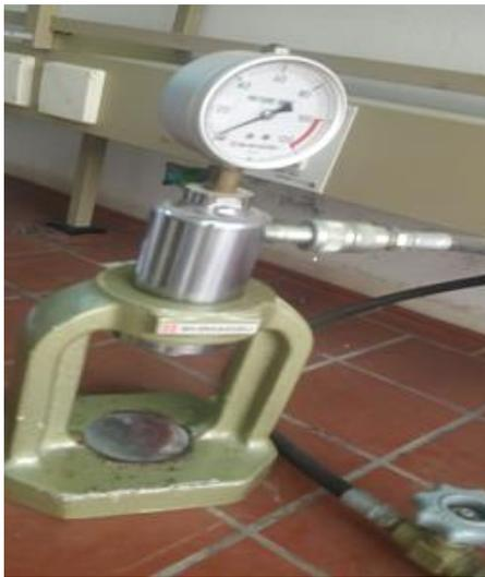
Fig. 19: Presse hydrostatique
