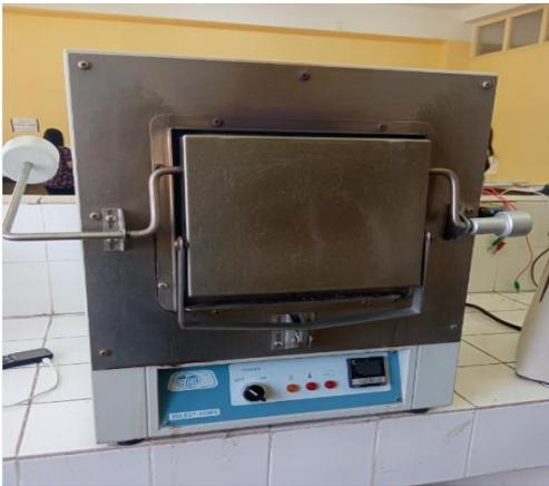
**Fig. 17:** Four utilisé pour la calcination
