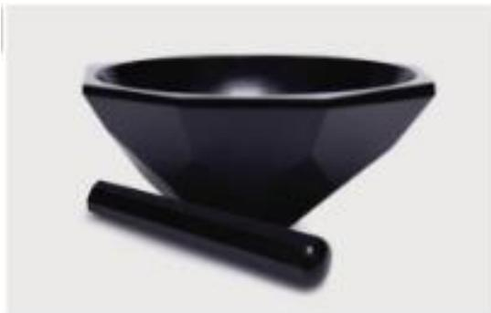
**Fig. 15:** Mortier en agate
