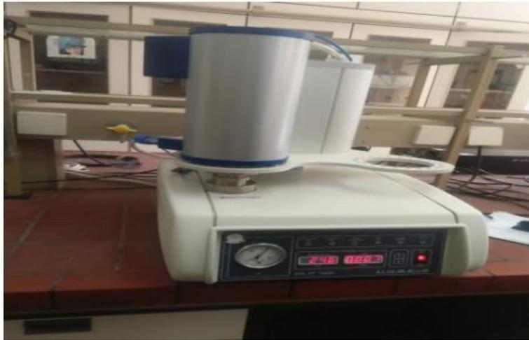
Figure 23 : L'appareil d'analyse ATG/DTG.
