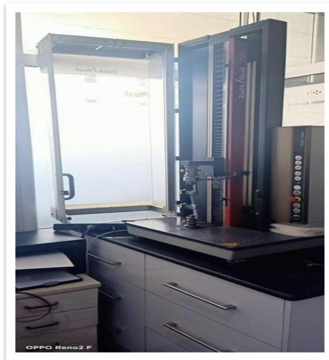
Figure 26 : Photo de la machine de traction utilisée.
