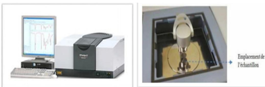
**Figure 22 : Spectromètre infrarouge.**
