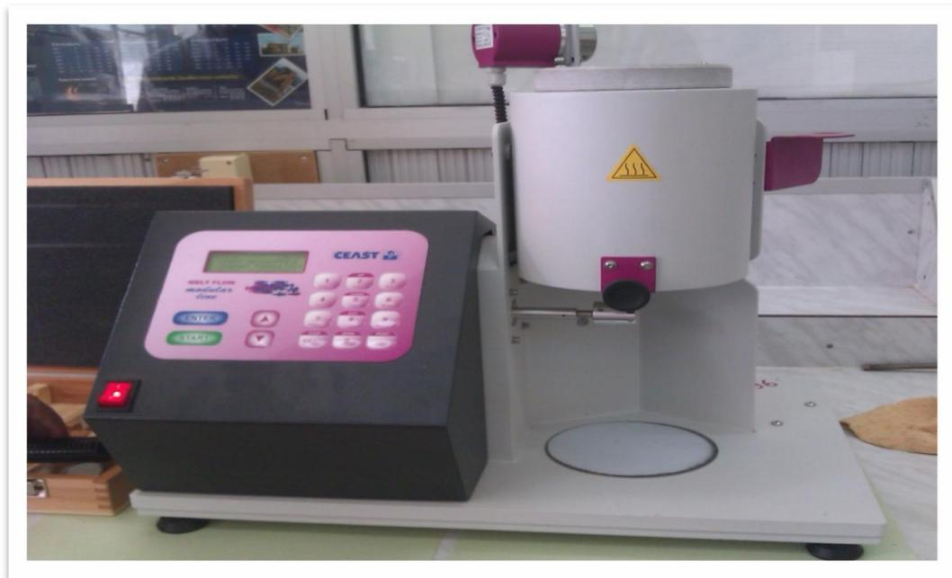
**Figure 27 : Appareillage de mesure de l'indice de fluidité.**
