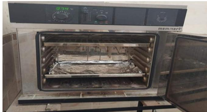
**Figure III.8.** Etuve utilisée (Type MEMMERT) pour le séchage de l'adsorbant
