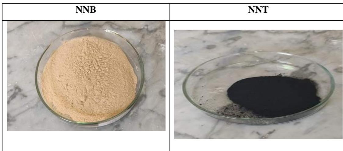
**Figure III.13.** Description de l'adsorbant avant et après traitement par pyrolyse
