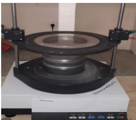
**Figure III.10.** Tamiseur utilisée type ReTSch
