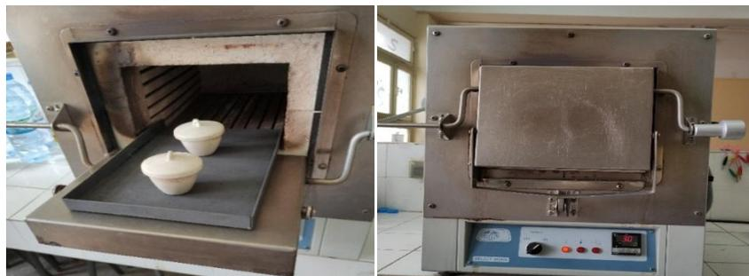
**Figure III.12.** Four utilisé pour l'activation physique (type SELECT – HORN) [1200°C]
