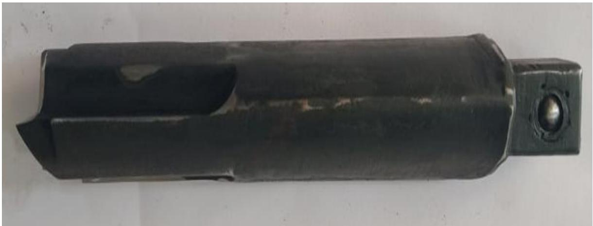
**Figure IV.28 :** L'outil de coupe après le traitement thermique.
