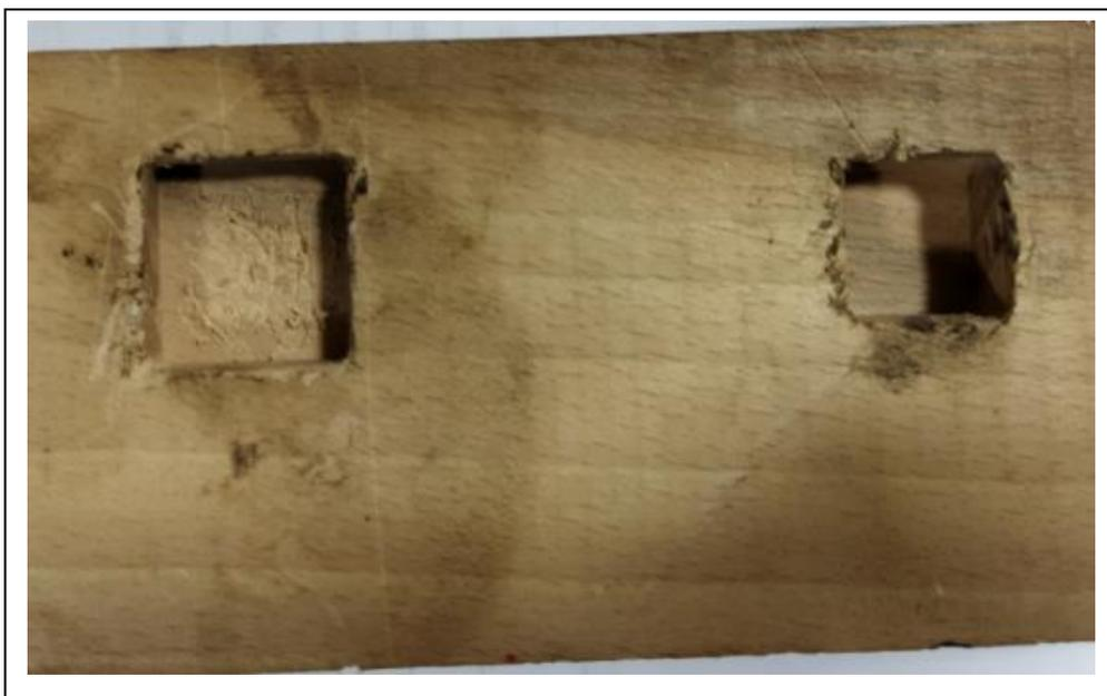
**Figure :** Le résultat obtenu du perçage carré.
