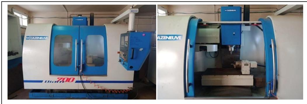
**Figure IV. 01** : Le centre d'usinage à quatre axes.
