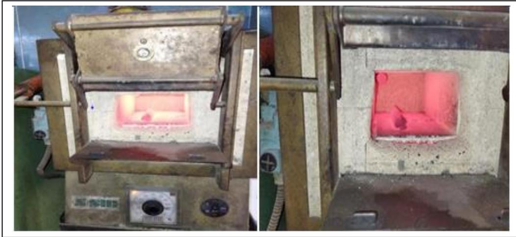
**Figure IV.25** : L'outil de coupe après une heure et demie sous la température de 840 °C.
