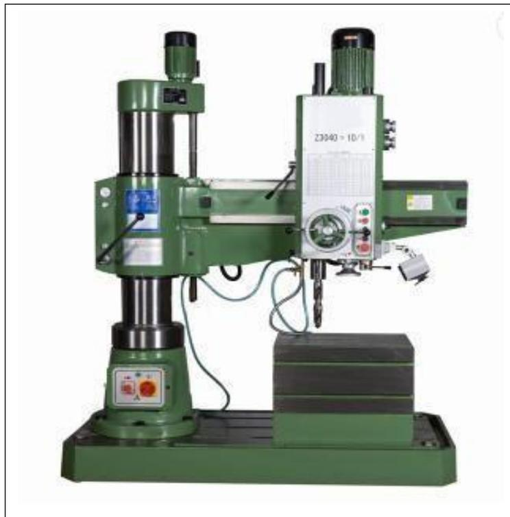
**Figure I.10 :** Perceuse radiale.
