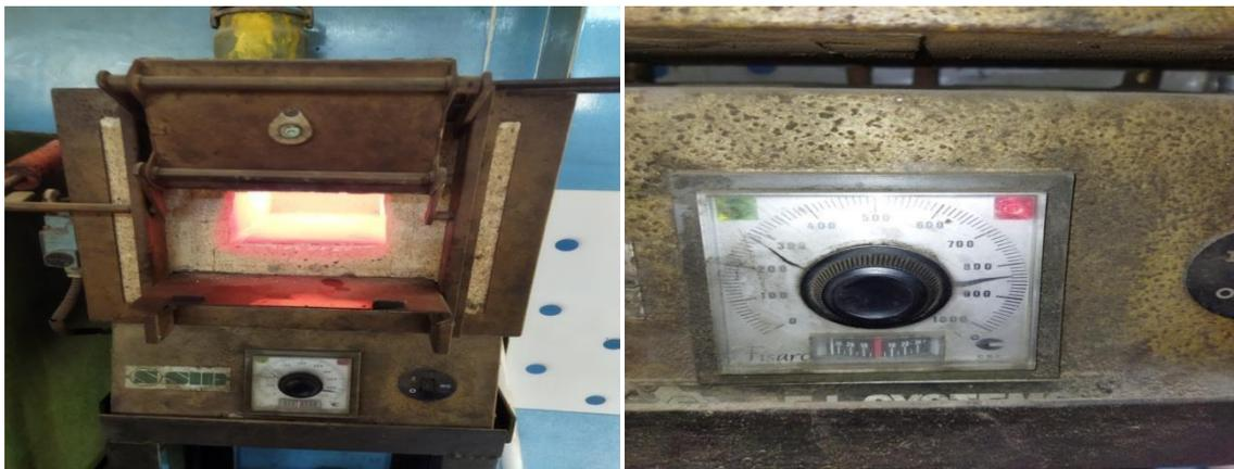
**Figure IV.24 :** Le four sous une température de 840 °C.
