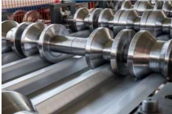
Figure I.04. Processus de profilage de tôles [techniques-ingenieur.fr].
