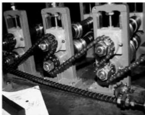
Figure I.09. Arbre de transmission entraîné par chaînes [19].
