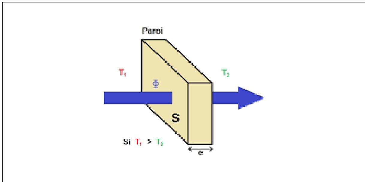
**Figure I.10 :** Transfert de chaleur dans une paroi verticale chauffée.
