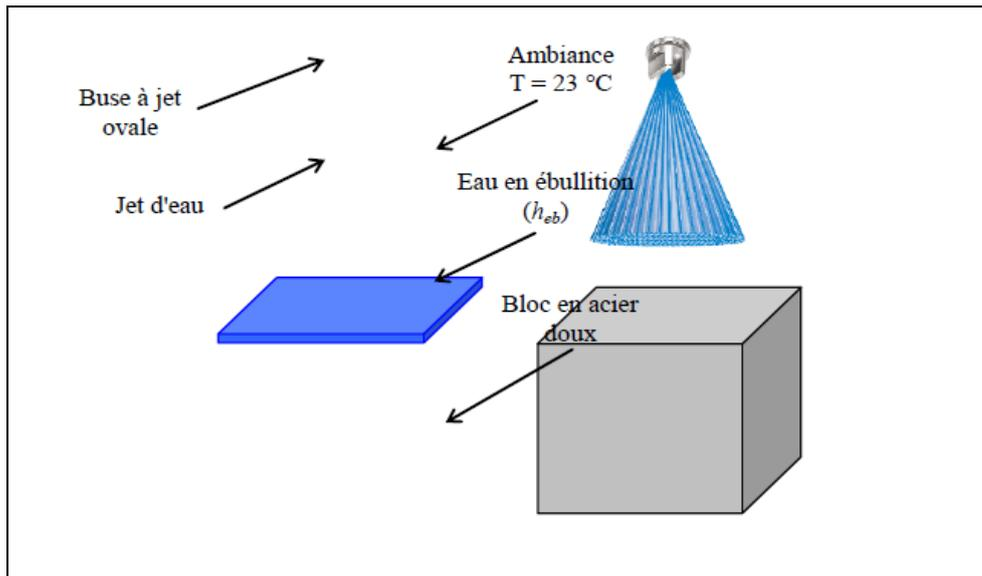
**Figure I.11** : Conduction thermique dans les solides lors d'un refroidissement convectif
