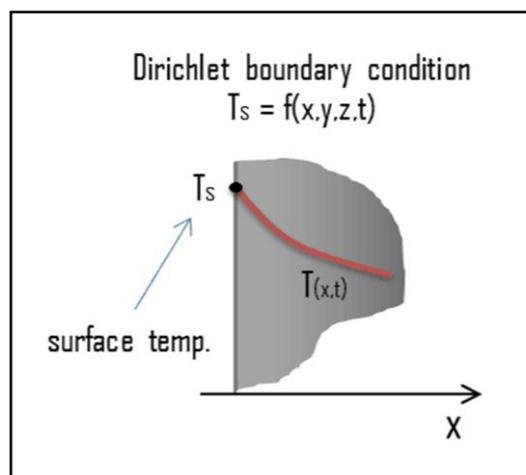
Figure I.7 : Conditions aux limites de Dirichlet
