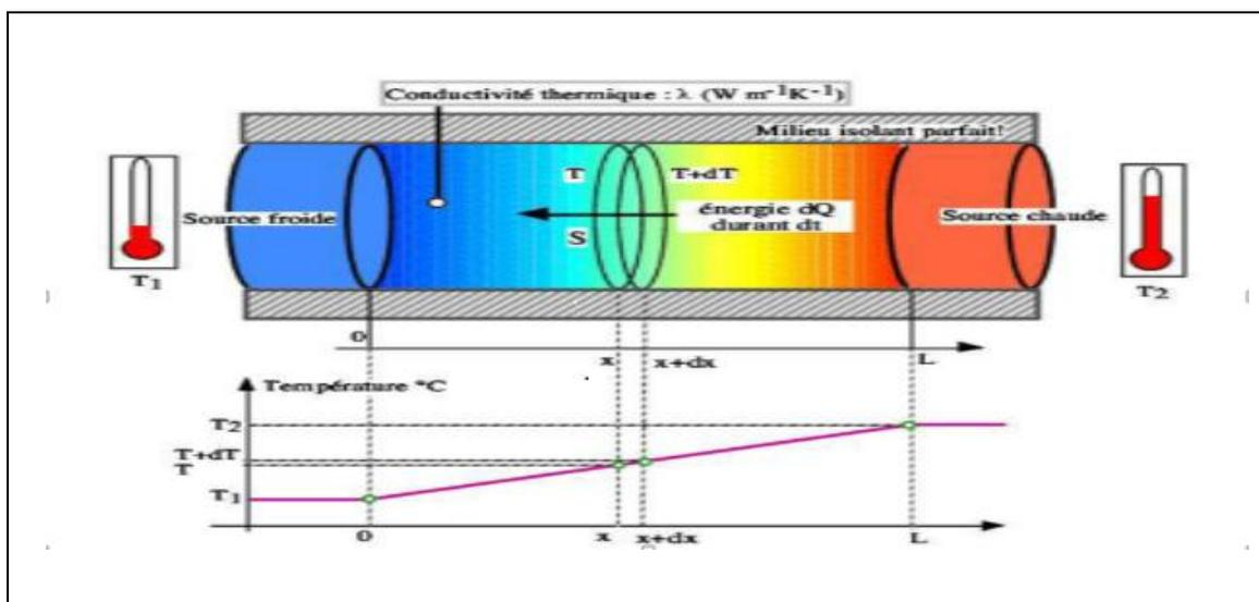
Figure I.5 : Principe de la conduction thermique.
