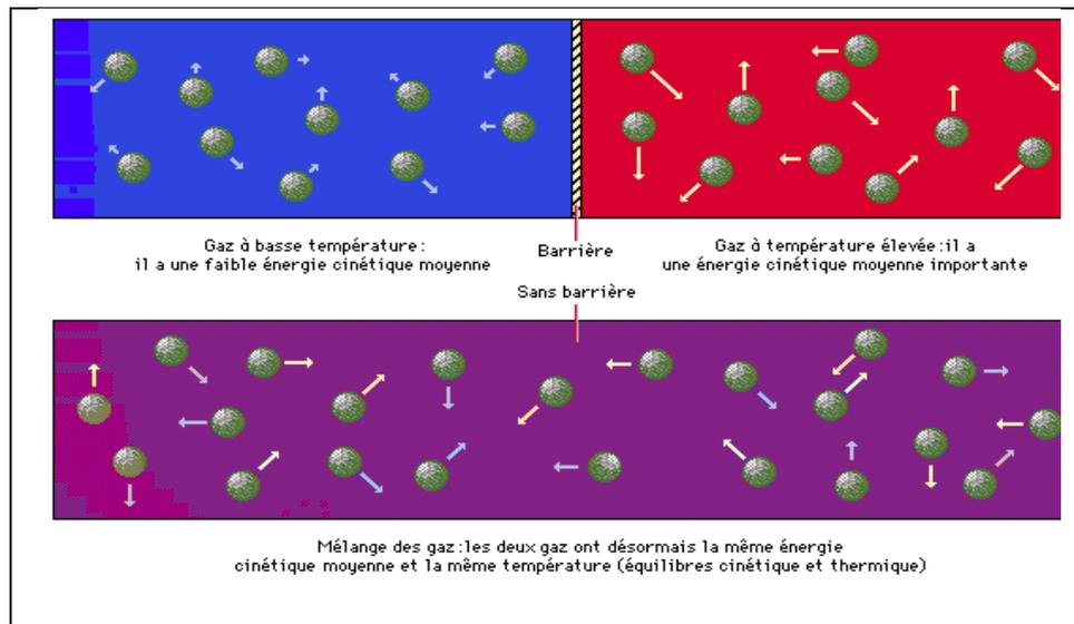
**Figure I.1 :** Illustration des notions de transfert de chaleur, de température et d'équilibre.
