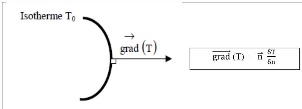
Figure I.2 : Isotherme et gradient thermique.
