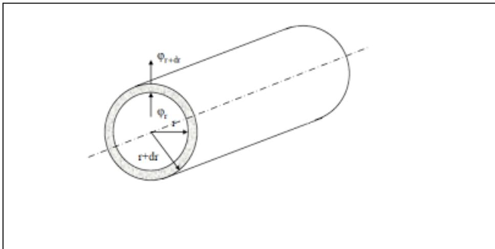
**Figure I.9 :** transfert de chaleur dans un cylindre.
