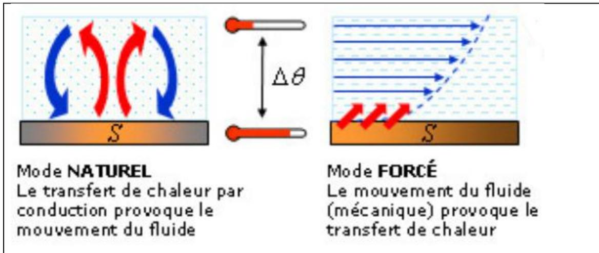
Figure I.4 : Schéma représentatif de la convection thermique.
