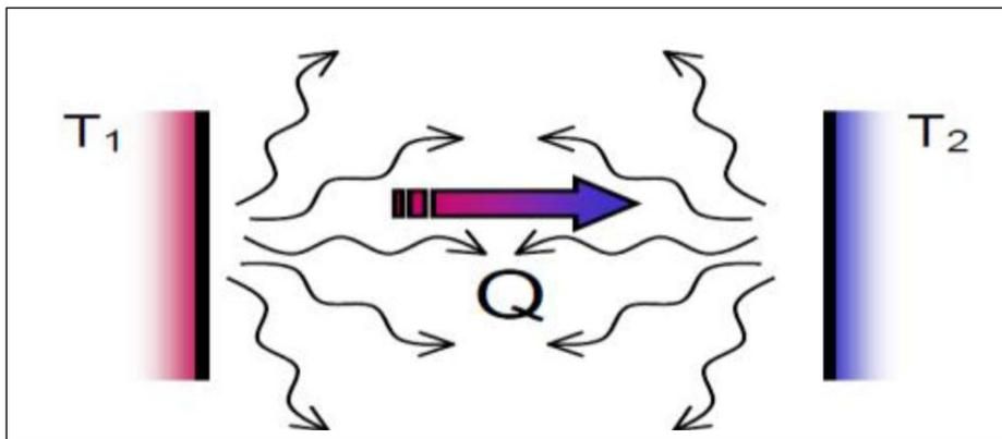
Figure I.3 : Schéma représentatif du rayonnement
