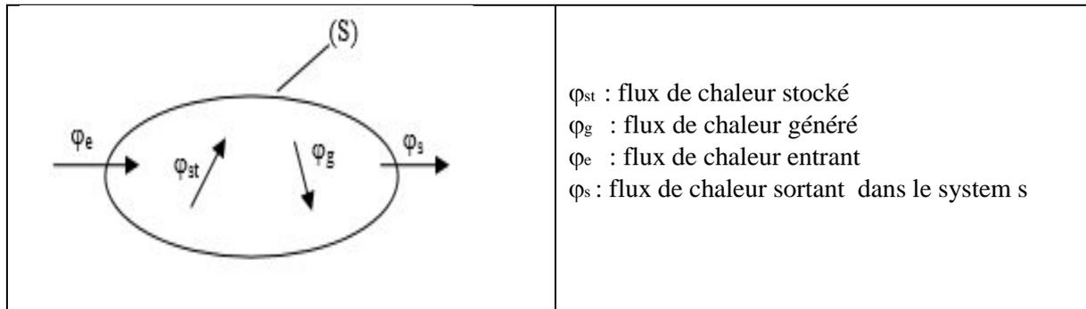
**Figure I.6 :** Système et bilan énergétique.
