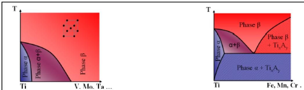
**Figure I.6** Diagramme de changement de phase entre le titane et les éléments bêta gènes isomorphes (à gauche), les éléments bêta gènes eutectoïde (à droite) [7].
