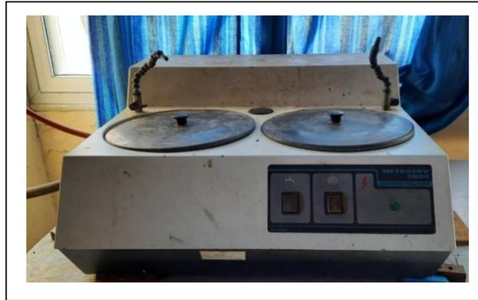
**Figure III.2** : Polisseuse de marque METASERV 2000.
