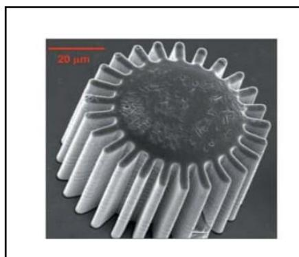
**Figure II.11** Image d'un engrenage en alliage amorphe obtenue par coulée en moule. Image copiée du site de la société liquidmetal ([www.liquidmetal.com](http://www.liquidmetal.com)).
