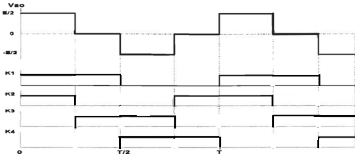
**Figure II.15 :** Formes d'ondes d'un bras d'onduleur triphasé de type FC à trois niveaux.
