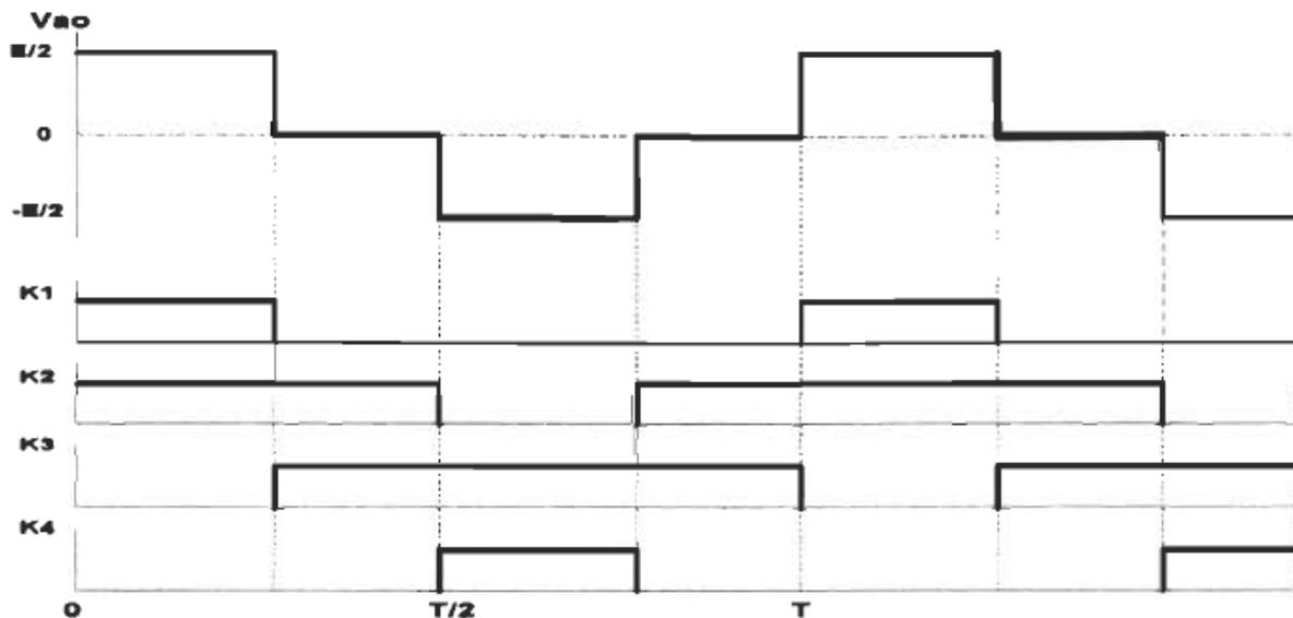
**Figure II.9:** Formes d'ondes d'un bras d'onduleur triphasé de type NPC à trois niveaux.
