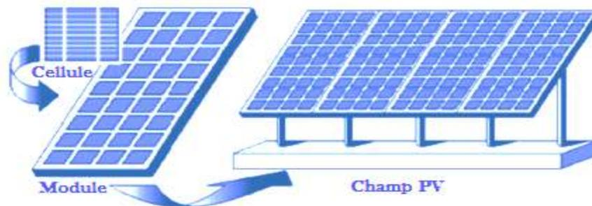
Figure I.8. De cellule au module au générateur photovoltaïque
