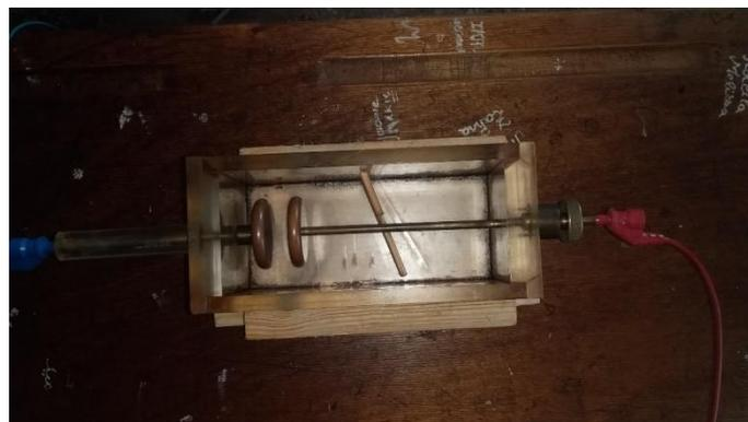
**Figure II.4 :** Cellule d'essais avec des électrodes planes.
