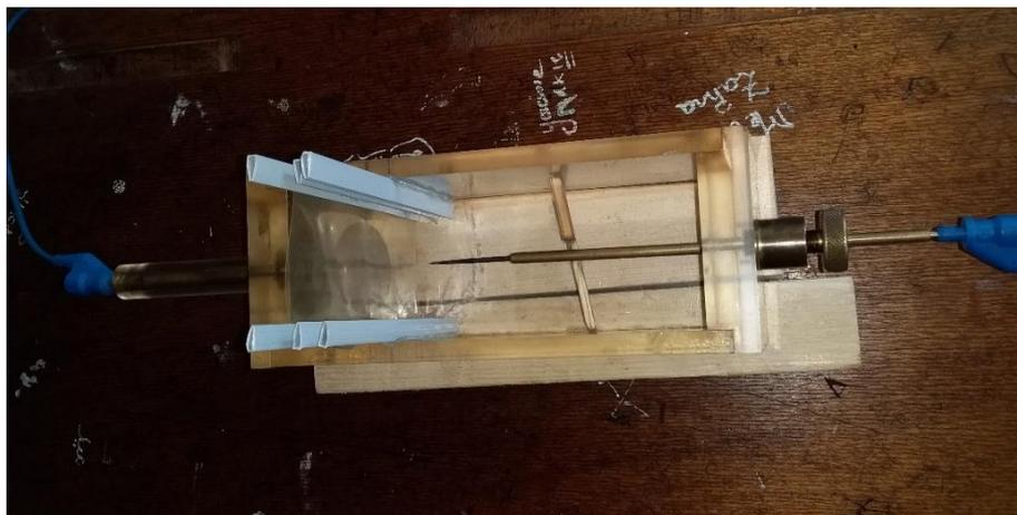
**Figure II.9 :** Influence de la position de la barrière isolante sur les tensions de claquage de l'air.
