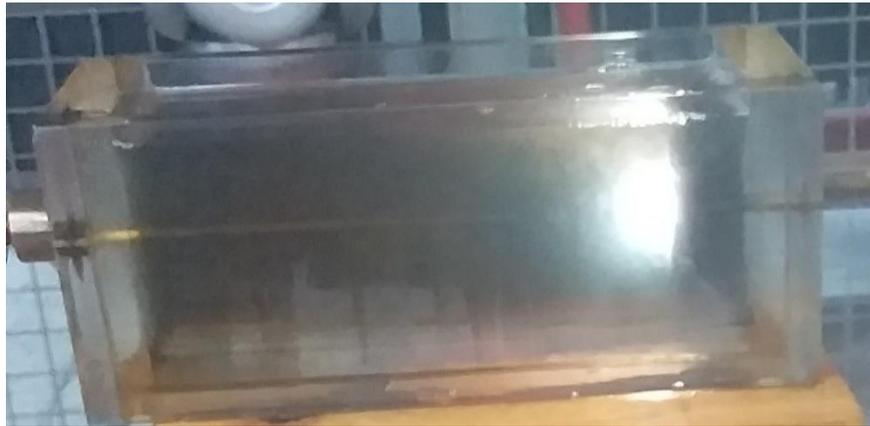
**Figure III.5 :** Photos des arcs électriques dans l'huile borak 22.
