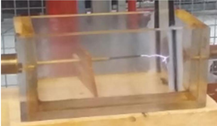
**Figure III.7** : Photo d'un claquage dans un espace d'air avec une barrière solide en géométrie pointe-plan.
