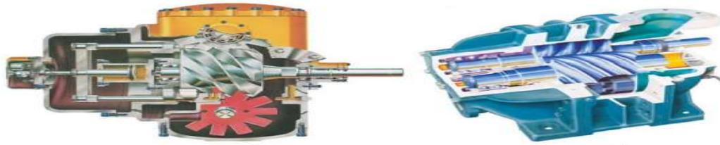
Figure 9: Compresseurs à vis.
