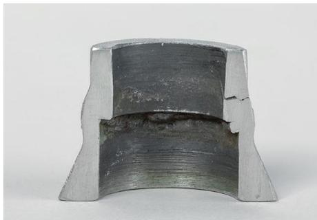
**Figure I.9 :** Fissure due à la corrosion sous contrainte.
