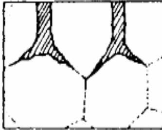
**Figure I.5 :** Schéma corrosion inter granulaire.
