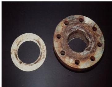
**Figure I.6 :** Corrosion caverneuse d'un acier allié sous un joint.
