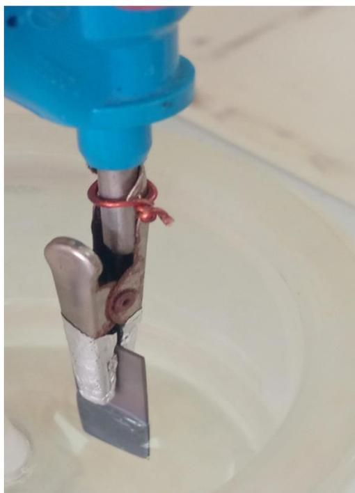
**Figure II.4 :** Électrode de travail en acier.
