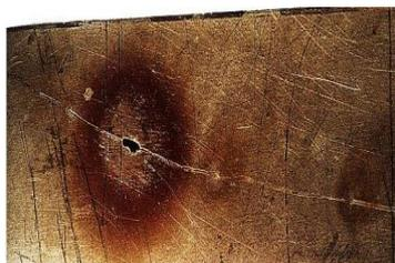
**Figure I.4:** corrosion par piqures.
