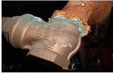
**Figure I.10 :** Corrosion galvanique résultante d'un assemblage de deux métaux différents : robinet en cuivre et conduite en acier galvanisé.
