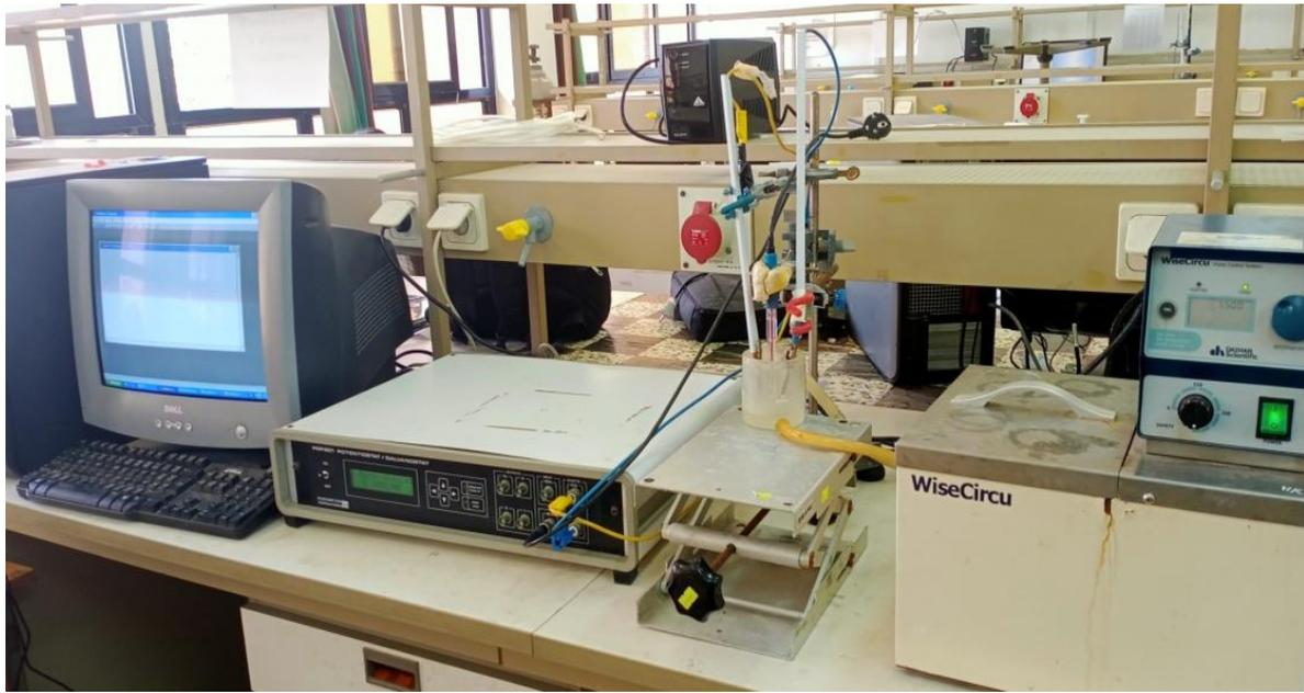
**Figure II.6 :** Dispositif expérimental de mesure potentiodynamique, potentiostatique et galvanostatique.
