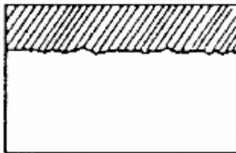
**Figure I.3 :** schéma de corrosion uniforme
