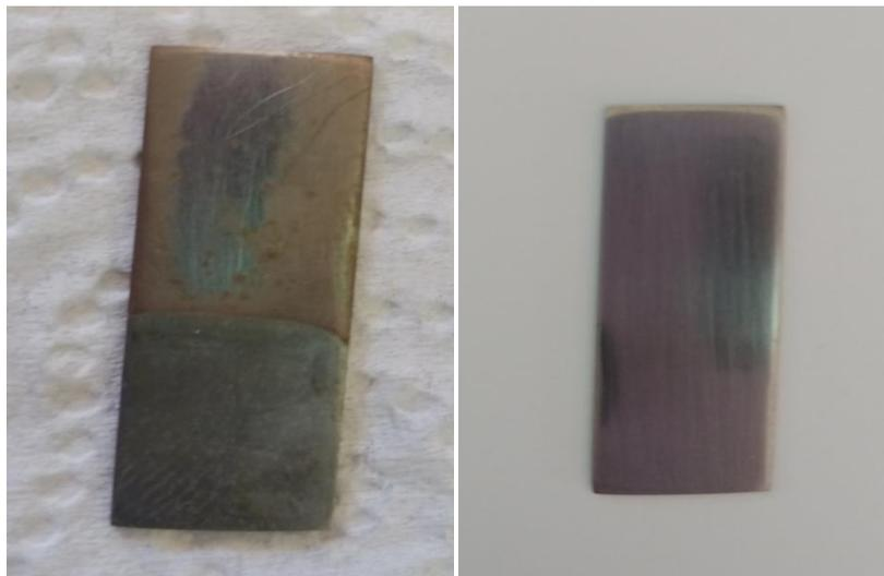
**Avant****Après****Figure II.2 :** La plaque de l'acier utilisée au cours des essais étudiée avant et après polissage.
