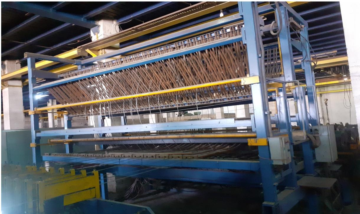
**Figure II.8 :** Boucle de compensation des fils de chaîne
