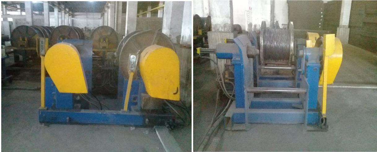
**Figure II.9 :** *Dévidoir de fils de trame*
