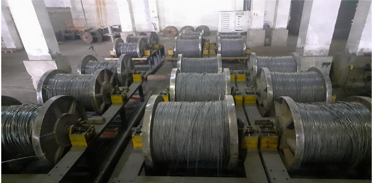
**Figure II.6 :** *Dévidoir de bobines de fils de chaîne*
