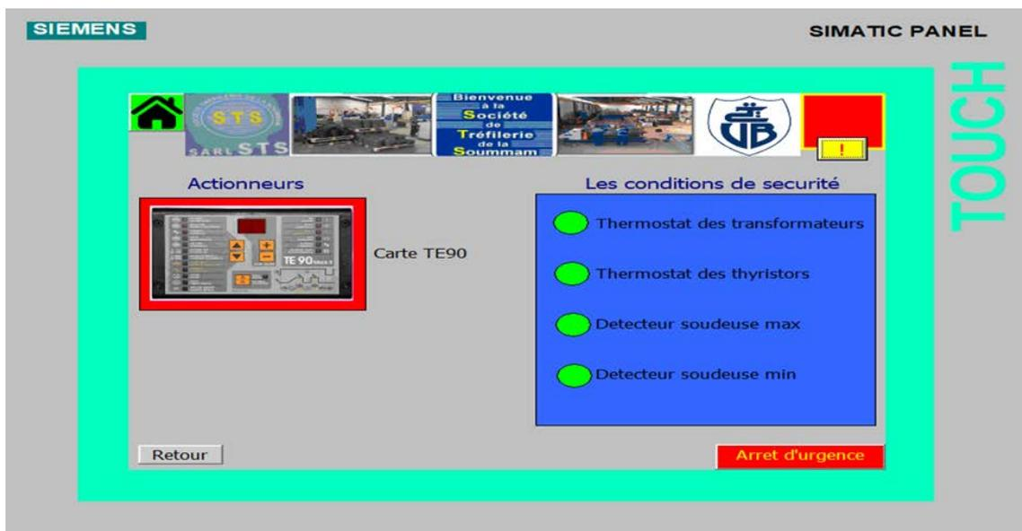
Figure IV.8 : Vue des actionneurs et des conditions de sécurité de la soudeuse
