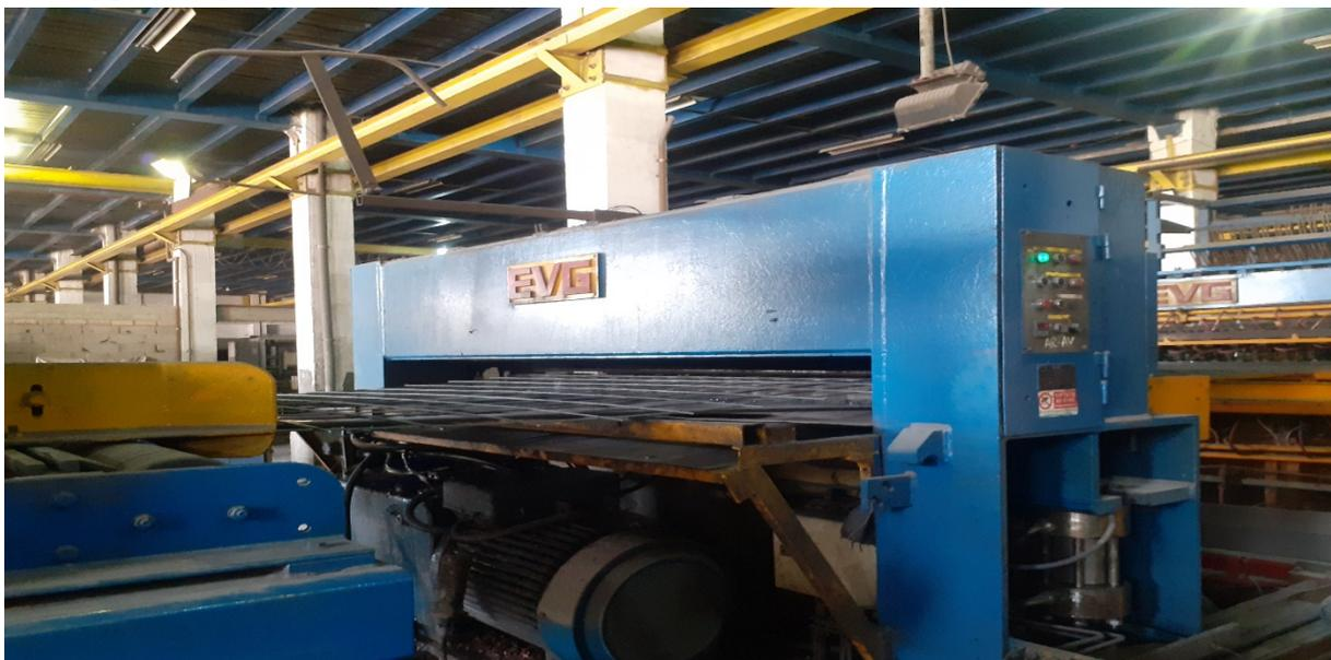
**Figure II.15 :** Cisaille de nappe M35/102
