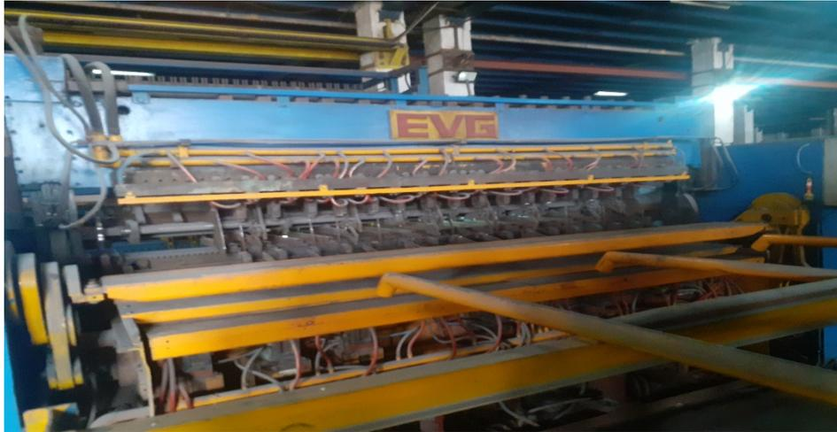
**Figure II.11 :** Banc de tirage de réglage du pas de soudure
