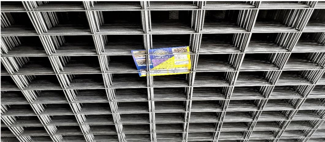
**Figure II.1 :** Treillis soudé en panneaux fabriqué par la STS
