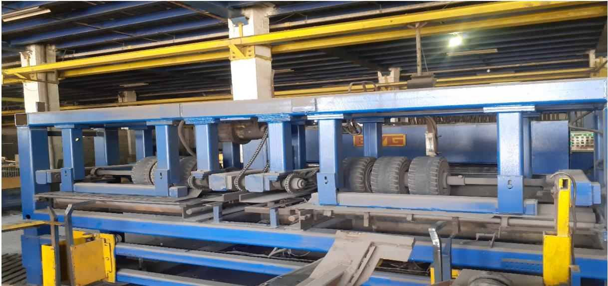
**Figure II.16 :** *Dispositif d'avancement de nappes de treillis avec roues pneumatique*
