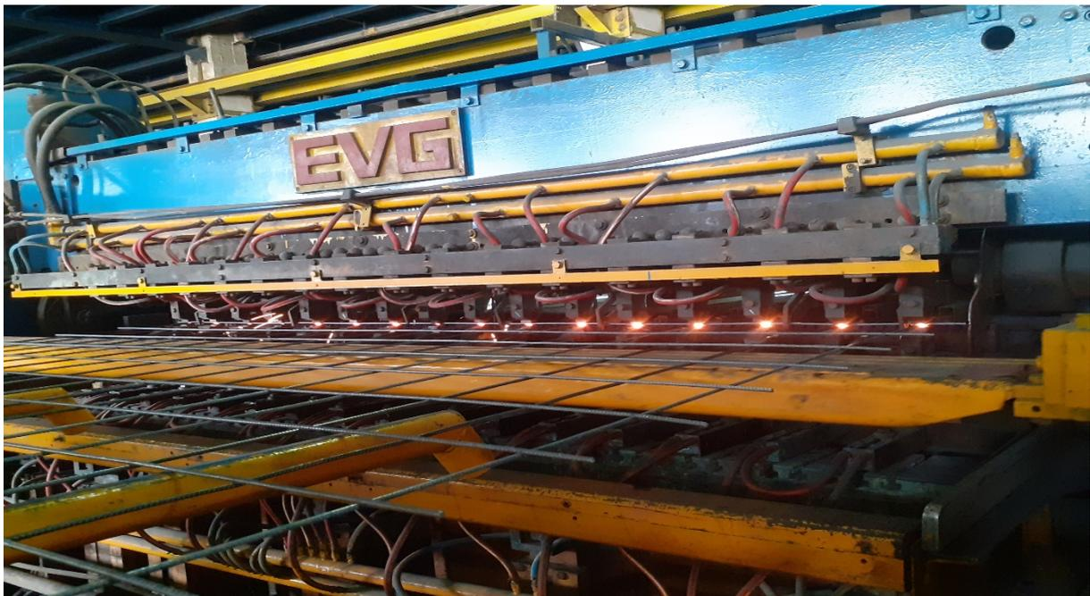
**Figure II.13 :** Soudeuse de treillis EVG M95/102
