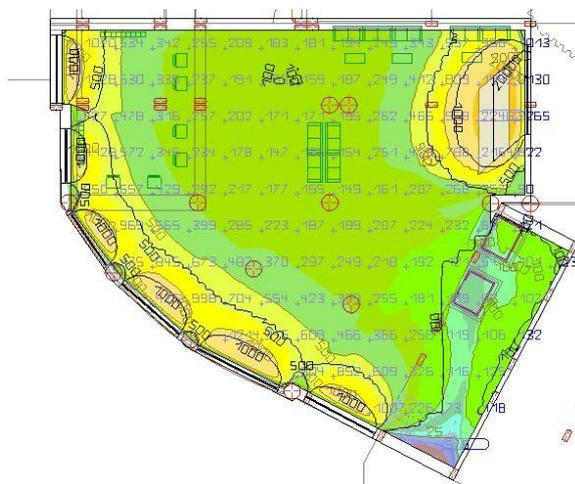
Figure : Résultats de la simulation sur DIALux Evo pour l'espace d'accueil orienté à l'Ouest à 08 : 30 h.
