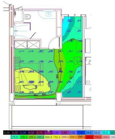
**Figure 98 :** Capture d’écran des résultats obtenues par DIALux Evo de la chambre (Sud-Ouest) au niveau du 5<sup>ème</sup> étage à 12 : 00 le 21/06/2021. **Source 93 :** L’auteur, 2021.
