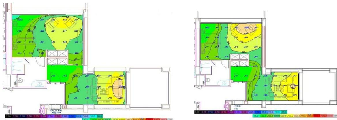
**Figure 97 :** Capture d’écran des résultats obtenues par DIALux Evo de la chambre suite (Nord-Est et Sud-Est) au niveau du 1<sup>ère</sup>, 5<sup>ème</sup> étage à 12 :00 le 21/06/2021.
