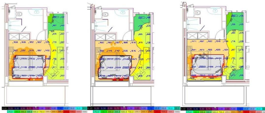
**Figure 94 :** Capture d’écran des résultats obtenues par DIALux Evo de chambre Sud-Ouest (à gauche l’escalier) 1<sup>ère</sup>,3<sup>ème</sup>, 5<sup>ème</sup> étage à 16 : 00 le 21mars/ septembre 2021.
