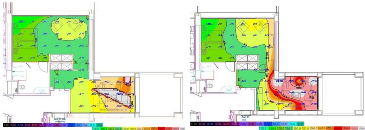
Figure 87 : Capture d’écran des résultats obtenues par DIALux Evo de la chambre suite au niveau 01<sup>ère</sup>, 3<sup>ème</sup> étage à 12 : 00 le 21/12/2020. Source 82 : L’auteur, 2021.
