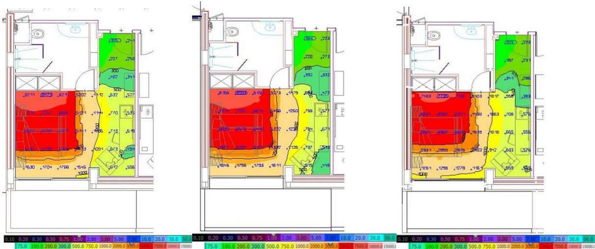
**Figure 89 :** Capture d’écran des résultats obtenues par DIALux Evo de chambre Sud-Ouest (à gauche l’escalier) 1<sup>ère</sup>, 3<sup>ème</sup>, 5<sup>ème</sup> étage à 16 : 00 le 21/12/2021.
