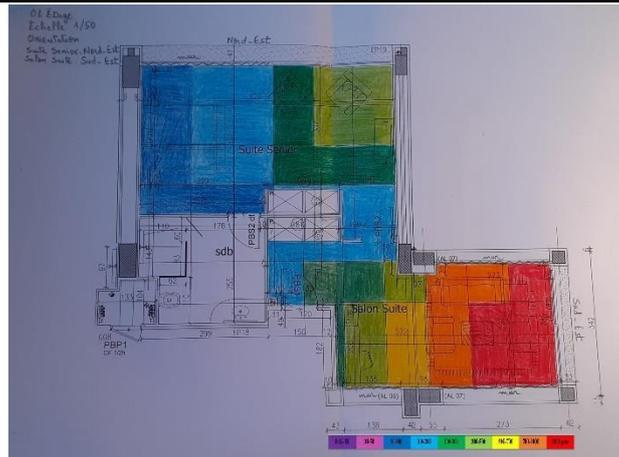
Figure 54 : Capture d'écran des résultats obtenues par DIALux Evo de la chambre suite au niveau du 1<sup>ère</sup> étage à 12 : 00.
