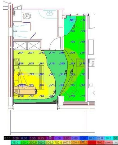
**Figure 93 :** Capture d’écran des résultats obtenues par DIALux Evo de la chambre (Sud-Ouest) au niveau du 5<sup>ème</sup> étage à 12 : 00 le 21 mars / septembre 2021. **Source 88 :** L’auteur, 2021.
