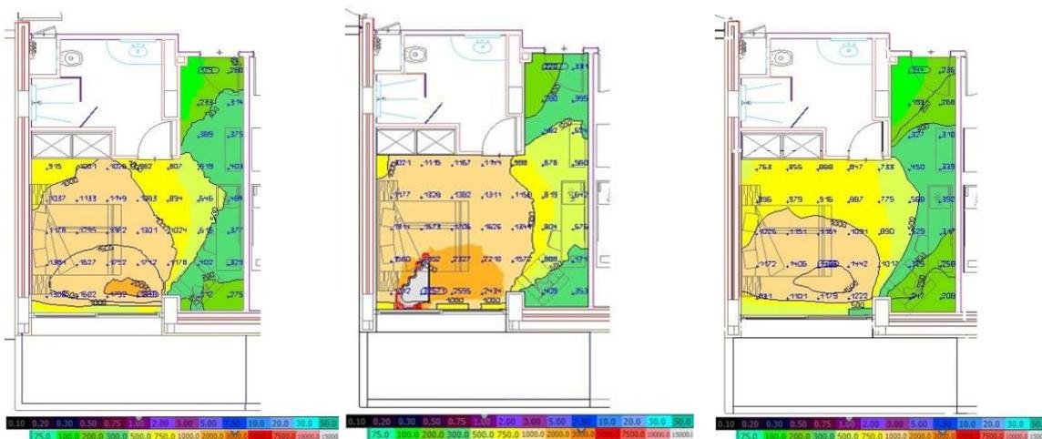
**Figure 99 :** Capture d’écran des résultats obtenues par DIALux Evo de la chambre (Sud-Ouest) au niveau du 1<sup>ère</sup>, 3<sup>ème</sup>, 5<sup>ème</sup> étage à 16 : 00 le 21/06/2021.
