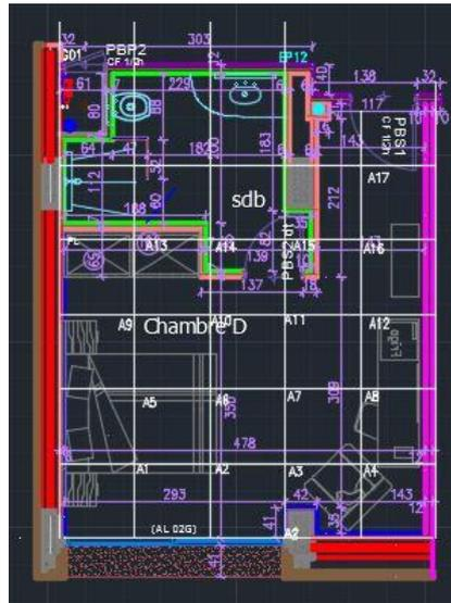
**Figure 31** : Capture d'écran d'un exemple d'une grille (1m/1m) tracé sur le plan d'une chambre double.
