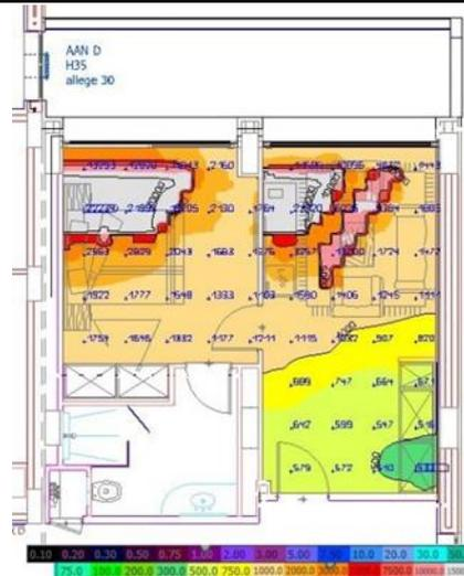
**Figure 96 :** Capture d’écran des résultats obtenues par DIALux Evo de la chambre suite (Nord-Est) au niveau du 5<sup>ème</sup> étage à 08 :30 le 21/06/2021.
