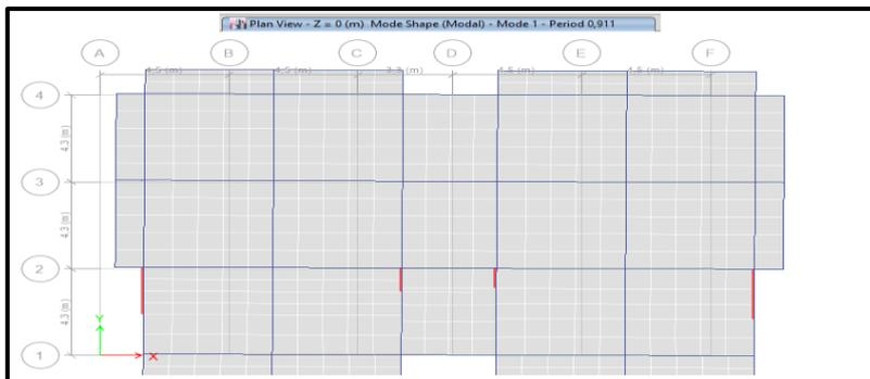
Figure IV. 4 : Translation selon l'axe X-X (mode de vibration 1).
