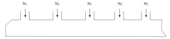
Fig VI.2 : schéma des semelle filantes
