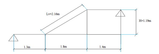
Figure II.5 : Schéma statique d'escalier.
