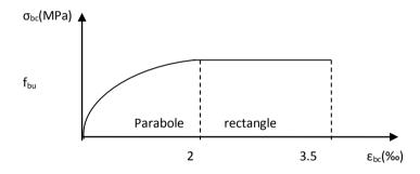
Fig.I.2 : Diagramme des contraintes du béton.
