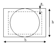
Figure III.14 .: Section creuse équivalente
