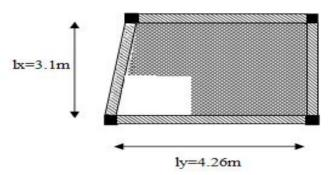
Figure.III.8 Dalle sur quatre appuis D3
