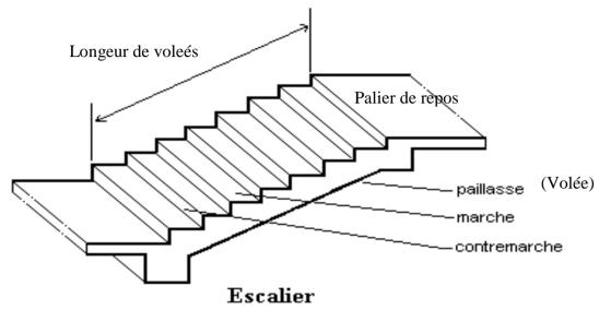
Figure II.4 : Schéma d'escalier.
