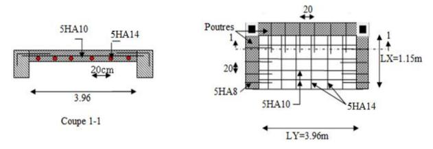
Fig III.6. Dalle sur deux appuis D2: (voir la Figure.III.5).
