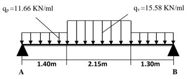
Figure.III.11. schéma statique de l'escalier
