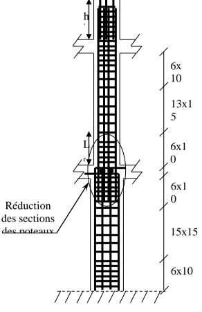
**Figure V. 3**: Disposition des armatures des poteaux
