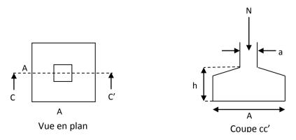
Figure VI.1 : Schéma d'une semelle isolée
