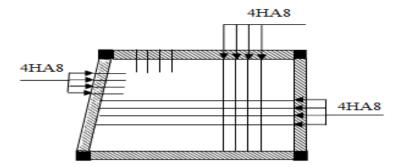
Fig III.9 : Schéma de ferraillages de la dalle sur 4 appuis
