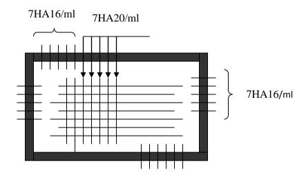
Figure VI.5 : Schéma de ferraillage du radier
