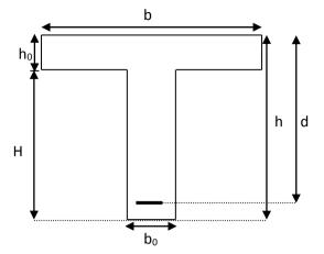
Figure.III.3. coupe transversale d'une poutrelle
