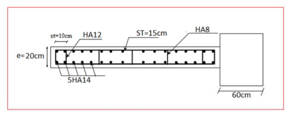
Fig. V.8 : Schéma de ferraillage du voile RDC
