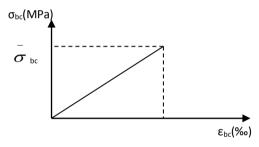
Fig.I.3: Diagramme des contraintes limite du béton.
