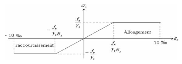
Figure I.4 : Diagramme contraintes-déformations de calcul acier
