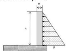
Figure VI.11. Poussée des terres sur les
