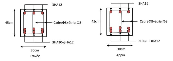
Figure III.15 : Schéma de ferraillage de la poutre palière
