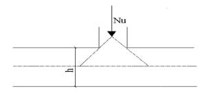
Figure VI.3: Schéma du poinçonnement
