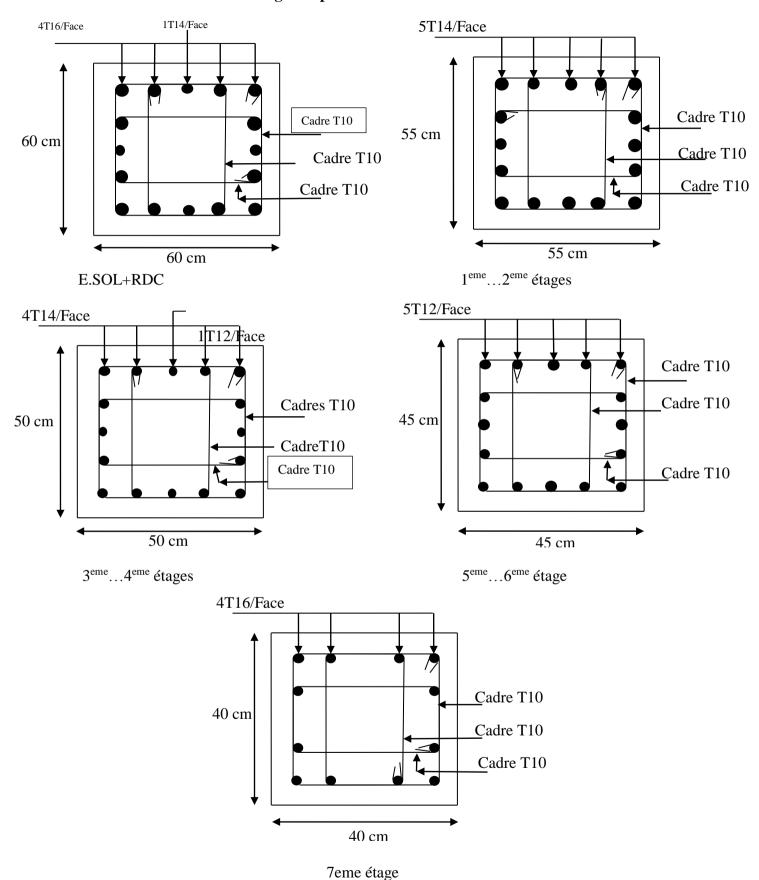
Figure V.4 : schéma de ferraillage des poteaux
