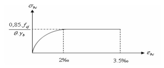
Figure .I.1 Diagramme contrainte-déformation pour le béton
