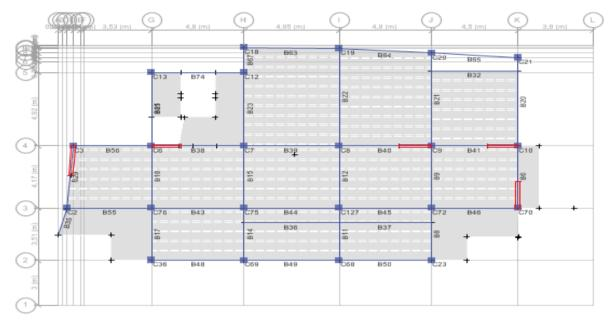
Figure.IV.2 disposition des voiles
