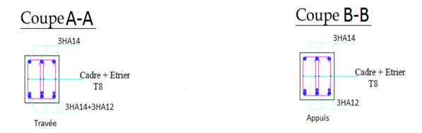
Figure III.17 Schéma de ferraillage de la poutre chainage
