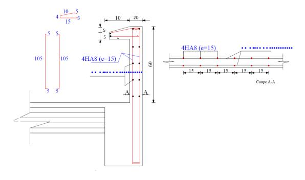
Fig III.19: Schéma de ferraillage de l'acrotère
