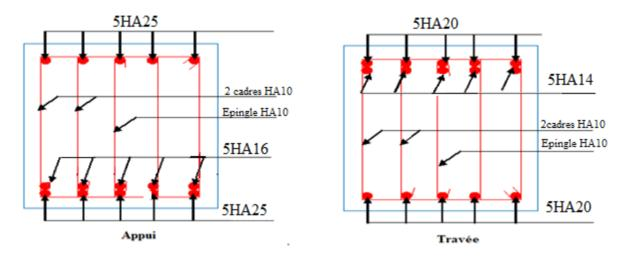
Figure VI.9. Ferraillage des nervures sens X-X.
