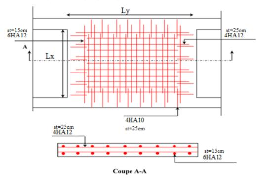
Figure VI.12. Schéma de ferraillage du voile périphérique
