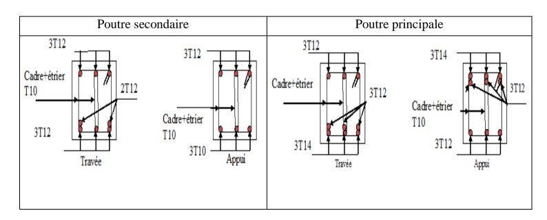
Fig V.5 schémas de ferraillage des poutres pour étages courants
