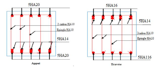
Figure VI.10. Ferraillage des nervures sens Y-Y.
