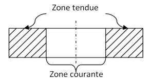
Figure V-7. Zone tendue et courante dans les voiles.
