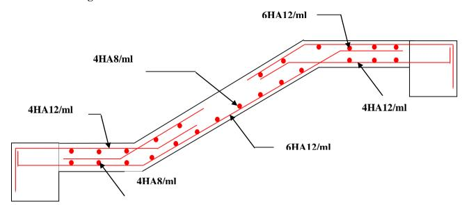
Figure.III.12. Schéma de ferraillage de l'éscalier
