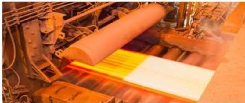
**Figure I.4.** Le laminage de la tôle à chaud.
