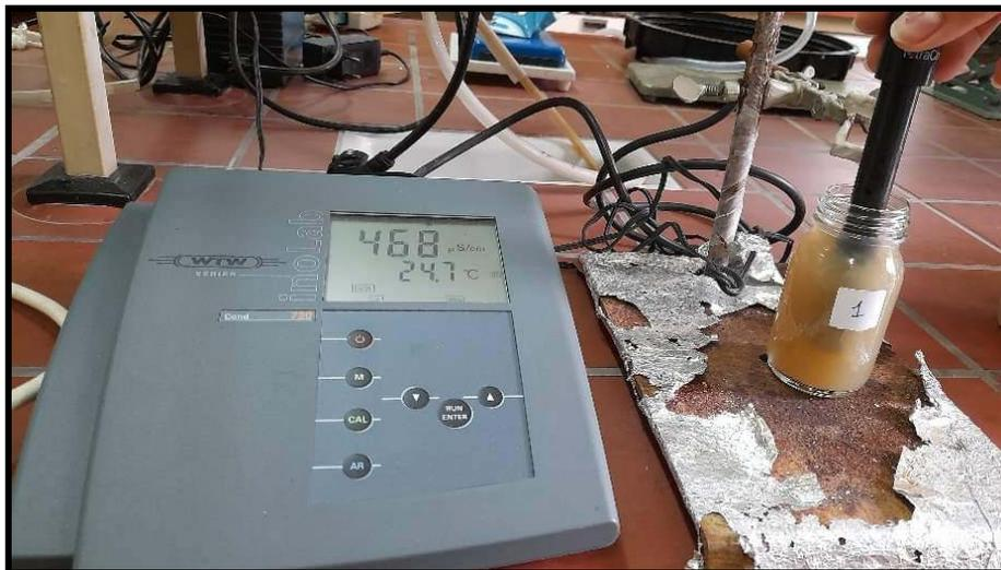
Figure II.7: Mesure de la conductivité à l'aide d'un Conductimètre.
