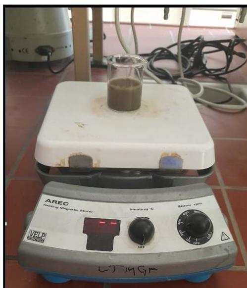
Figure II.3 : Photo d'une agitation magnétique
