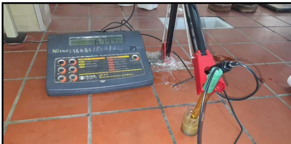
Figure II.6 : Mesure du pH à l'aide d'un pH mètre.
