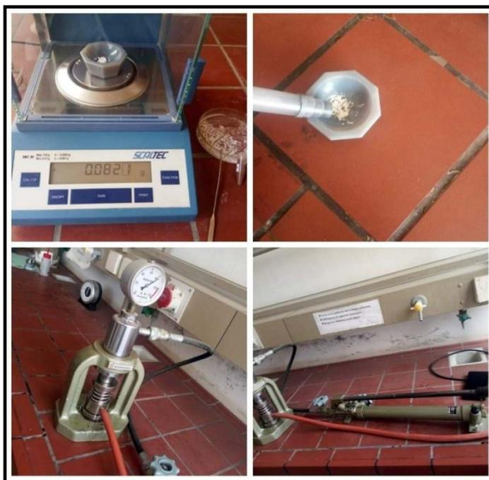
Figure II.11: Photos des étapes d'analyse spectroscopie infrarouge.
