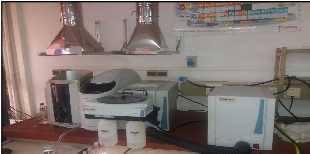
Figure II.14 : Photo de l'appareil du spectrophotomètre d'absorption atomique.
