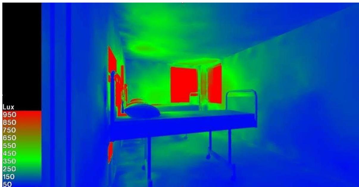
Figure 12 :: rendu d'image de la pièce étudiée simulée par le logiciel radiance (logiciel RADIANCE, 2021)
