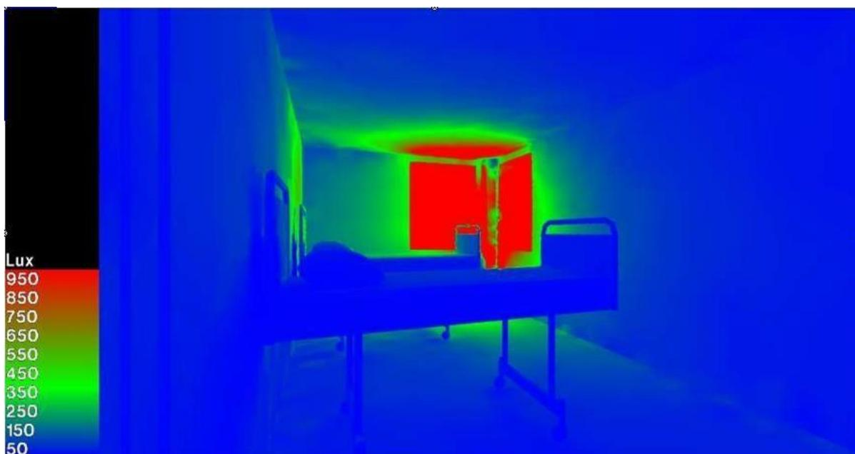
Figure 7 : rendu d'image de la pièce étudiée simulée par le logiciel radiance (logiciel RADIANCE, 2021)
