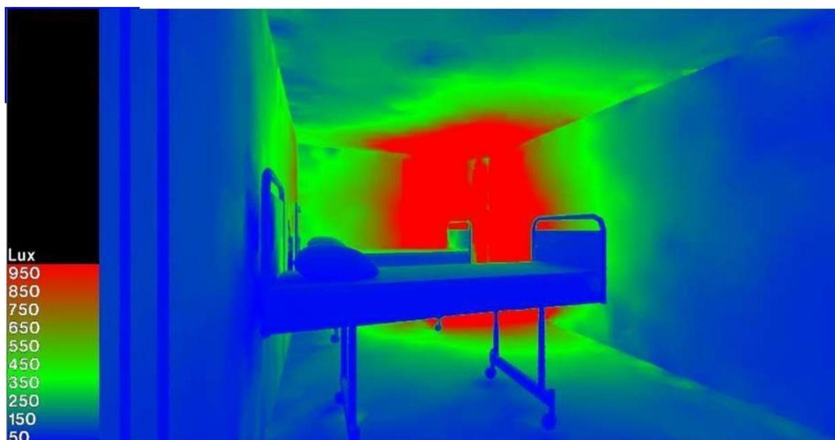
**Figure 8 : rendu d'image de la pièce étudiée simulée par le logiciel radiance (logiciel RADIANCE, 2021)**
