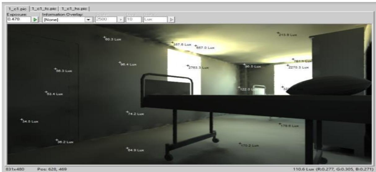
Figure 4-10: rendu d'image de la pièce étudiée simulée par le logiciel radiance (Auteur, 2021)
