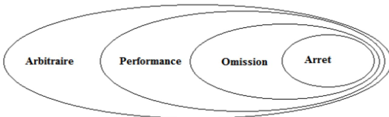
FIGURE II.2 – Classes des défaillances dans un système [28].
