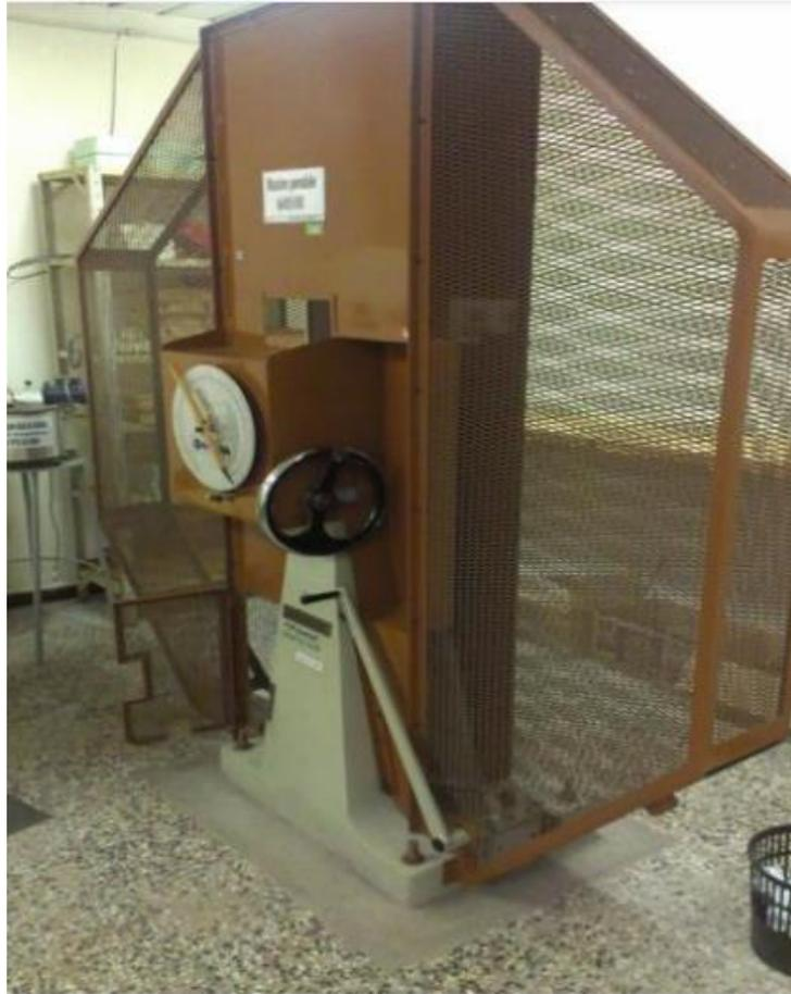
*Figure II.20 : Machine de résilience utilisée à l'ENMTP*
