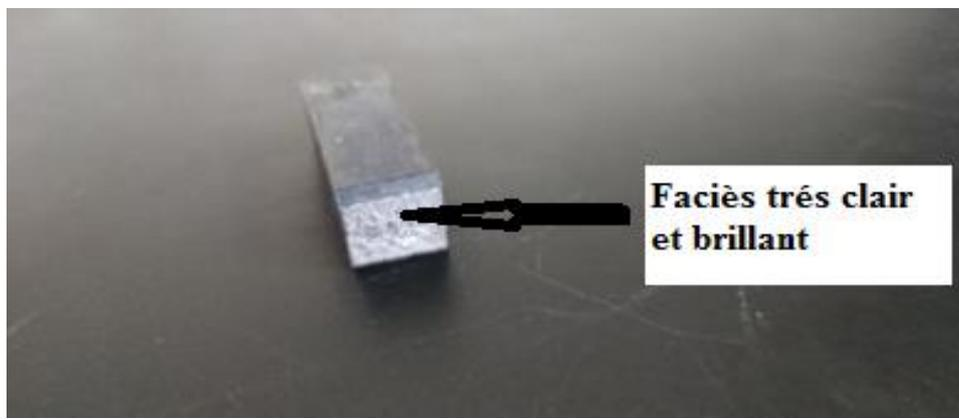
*Figure III.15 : facies de ruptures d'acier 35CrMo4.*
