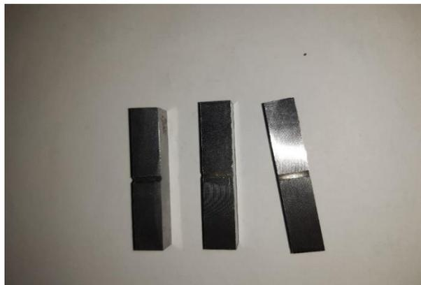
*Figure II.10 : Eprouvettes de résilience avec entaille V.*
