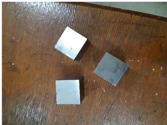
*Figure II.6 : éprouvette de dureté de forme cubique après fraisage.*
