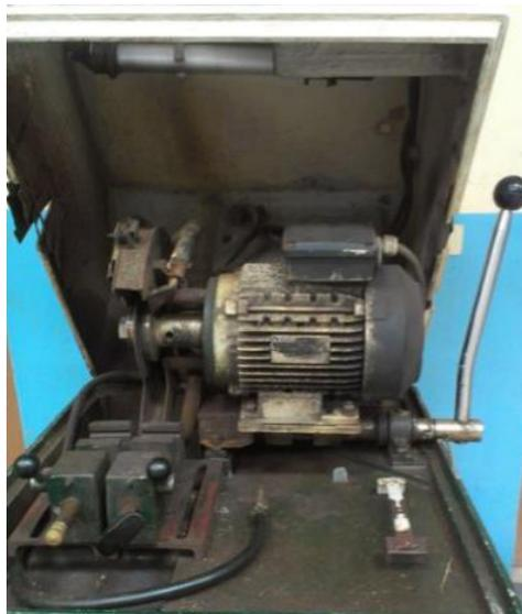
*Figure II.2 : Macro-tronçonneuse.*
