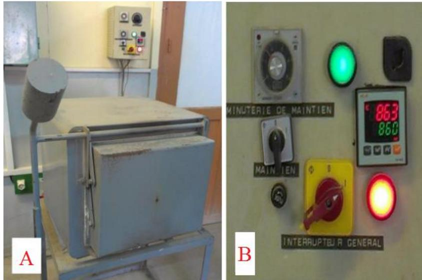
**Figure II.11 :** (A) Four à moufle (B) boîtier de commande de four.
