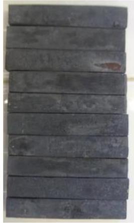
*Figure II.12 : Éprouvettes de résilience après le traitement thermique.*
