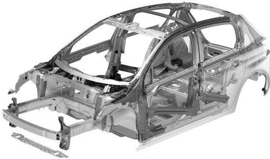
**Figure I.4** Châssis monocoque
