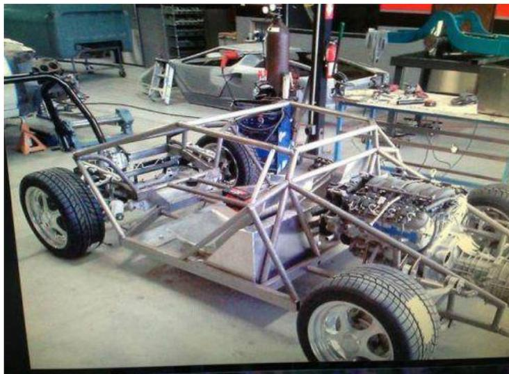
**Figure I.2** Châssis tubulaire
