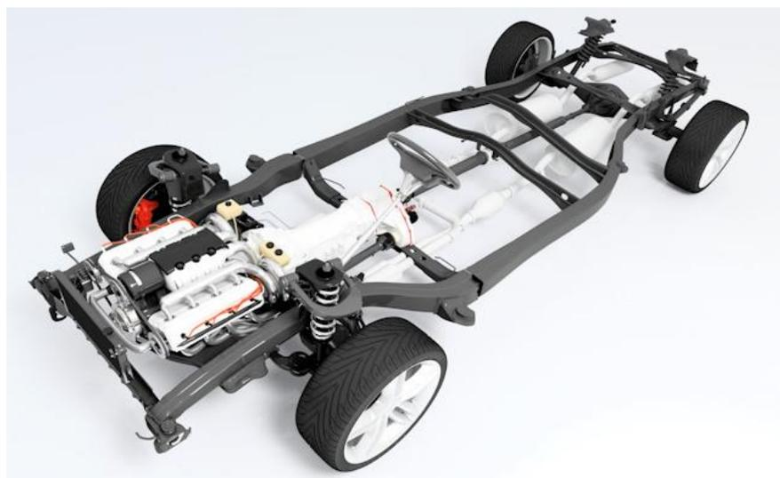
**Figure I.1** Châssis en échelle
