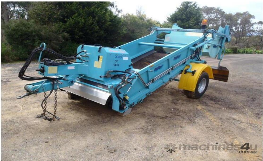
**Figure** Exemple d'une machine de nettoyage de sable de plages (Beach-Cleaner-Beach-Tech-STR2000)
