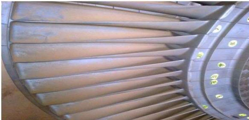
Figure (II.13) : les aubes de la turbine.
