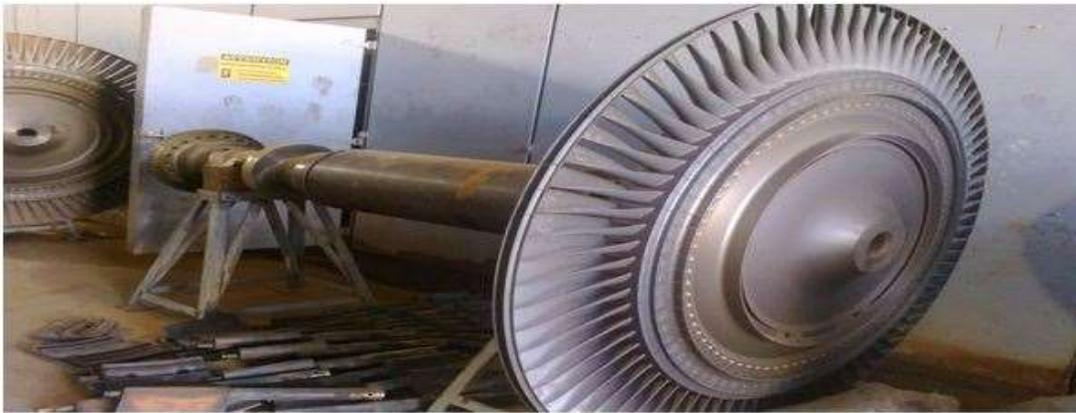
Figure (II.12) : Vue du rotor de la turbine basse pression.
