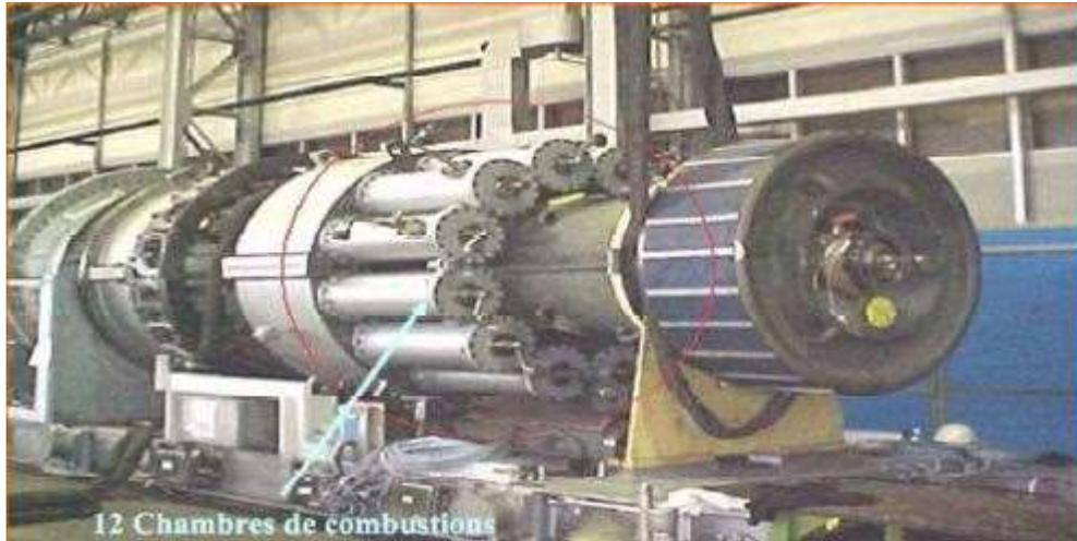
Figure (II.5) : Chambre de combustion de la turbine à gaz MS 5002C.
