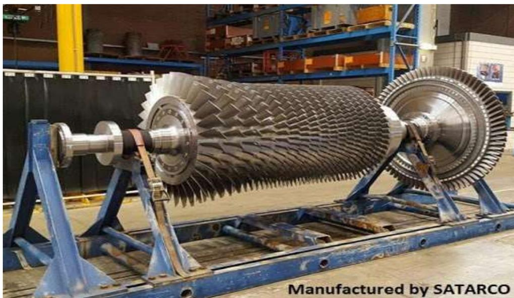
Figure (II-4) : Rotor du Compresseur de la turbine à gaz MS 5002C [7]
