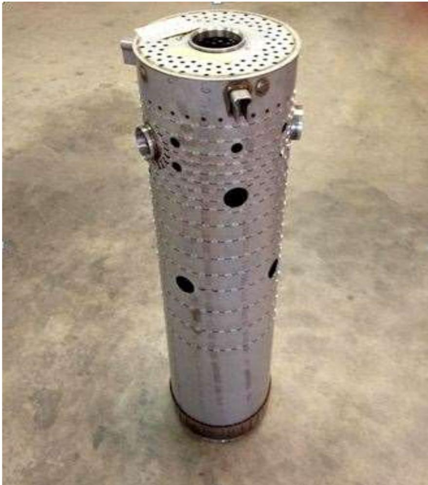
Figure (IV.1) : tube à flamme STD
