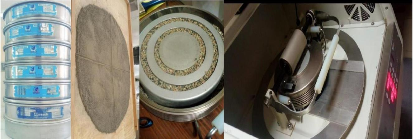
**Figure II.5** : préparation mécanique de déchet industriel.
