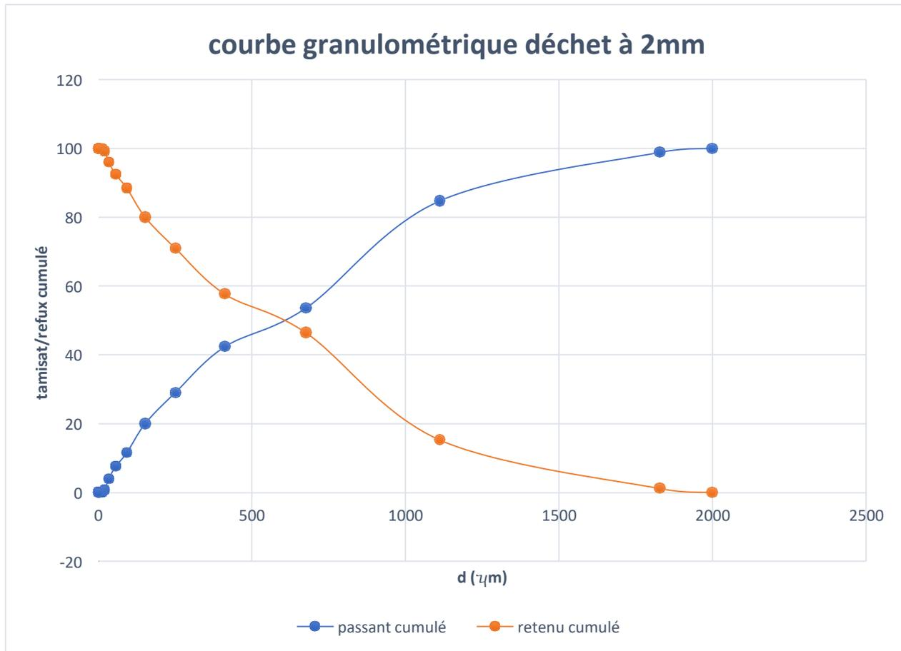
Figure III.4 : courbe granulométrique de déchet [0-2]mm
