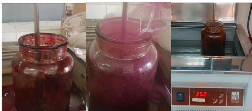
**Figure II.2 :** Etape d'ajout de l'eau bidistillée et la fin de bain glacé
