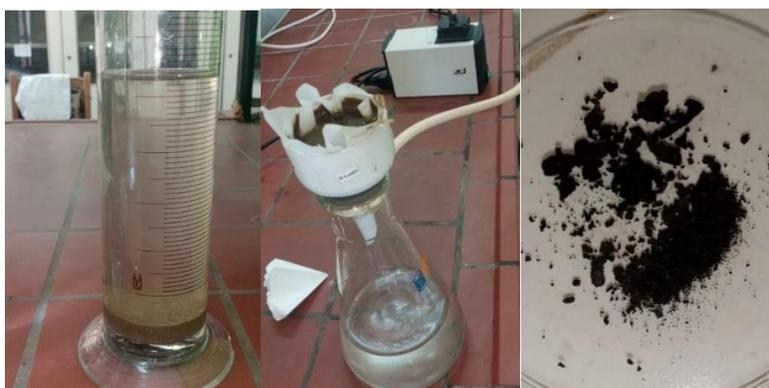
**Figure II.4 :** Etape de décantation, filtration, séchage de la préparation
