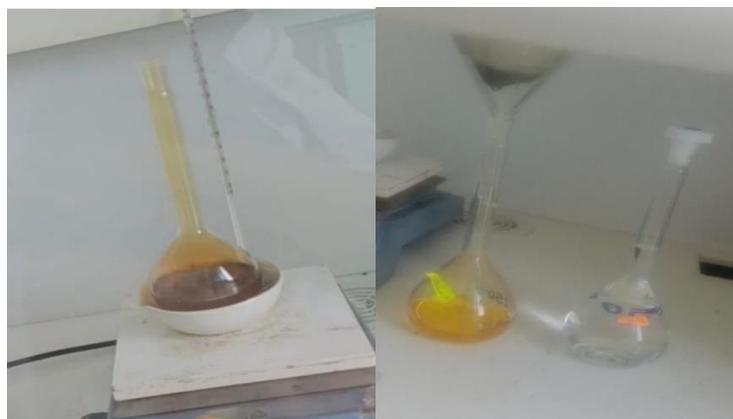
Figure II.9 : attaque acide (eau régale)
