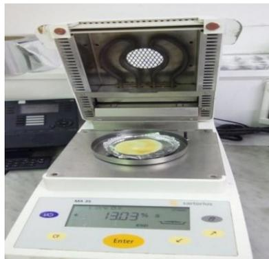
**Figure 08:** Photographie de l'échantillon dans le dessiccateur
