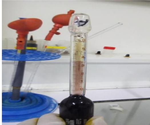
**Figure 09:** Photographie de l'échantillon dans un butyromètre
