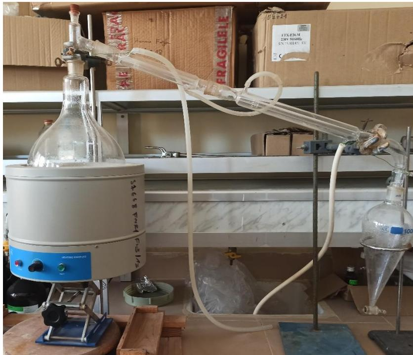
Figure 8: photographie d'un appareil pour l'hydrodistillation
