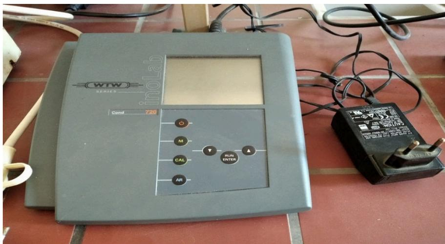
**Figure II.1. 3** Conductimètre de type WTW, Cond 720
