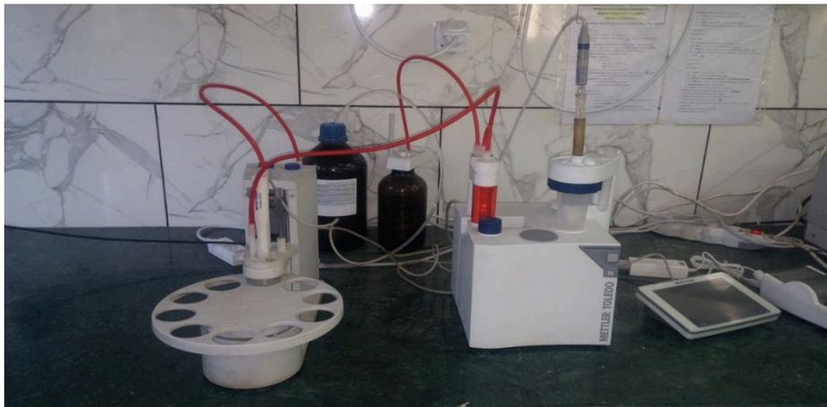
Figure I.2. 5Appareil de mesure de salinité. [1]
