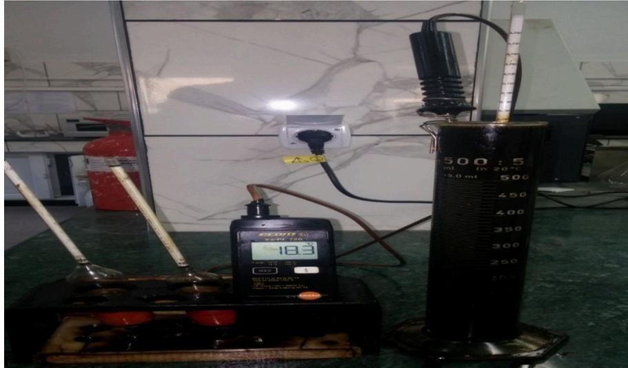
**Figure I.2. 2**Appareil de mesure de la densité. [1]
