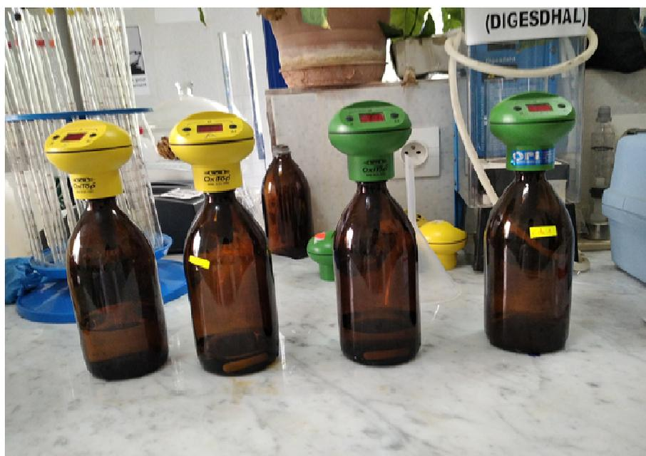
**Figure II.1. 6**Echantillons pris pour la DBO<sub>5</sub>
