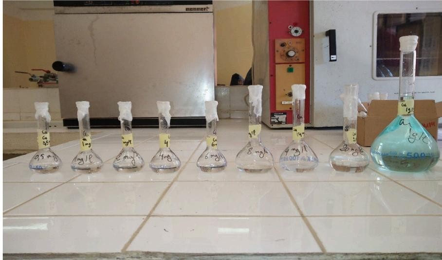
**Figure II.1. 16** Etalon de cuivre
