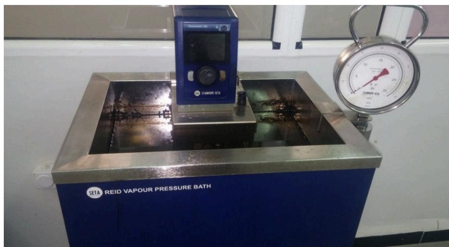
**Figure I.2. 3**Appareil de mesure de la tension vapeur. [1]
