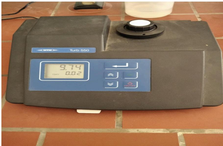
**Figure II.1. 4** Analyse d'échantillon par un turbidimètre WTW, turb 550.
