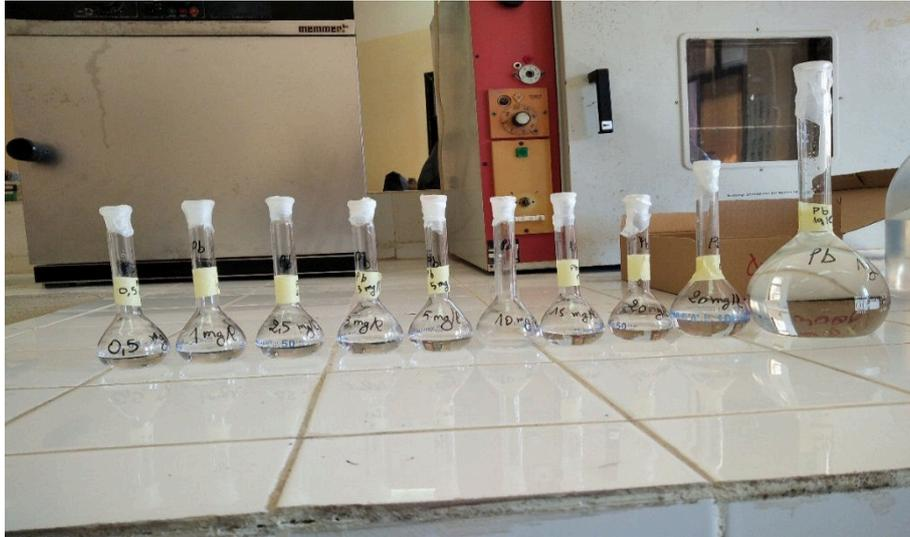
**Figure II.1. 13** Etalon de plomb
