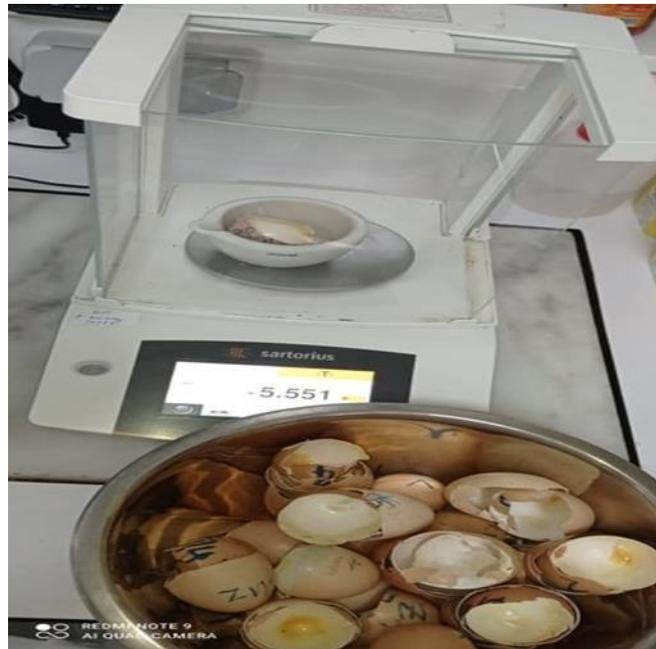
**Figure 9:** Photographie de la pesée des coquilles séchées.
