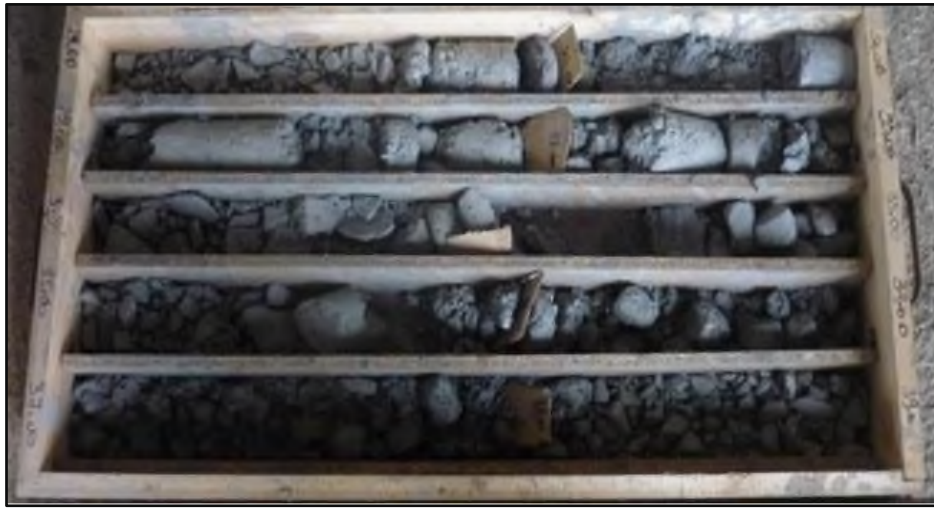
Figure III.3 Sondage effectué, la roche est complètement décompactée et argilifère (gouge de faille). [31]
