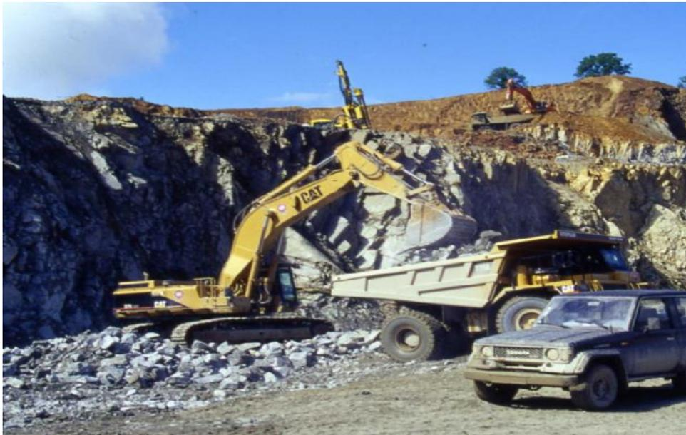
**Fig. II.9.** Chargement par pelle hydraulique
