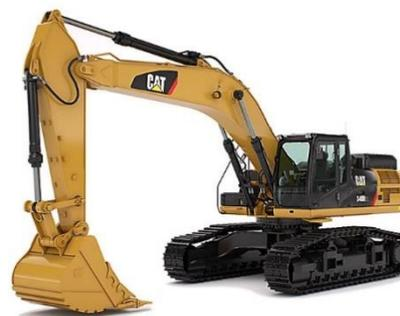
**Fig.III.3** : La pelle en rétro
