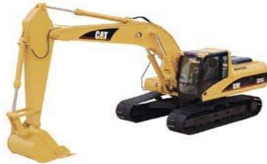
**Fig .III.5 :**la pelle hydraulique sur chenille
