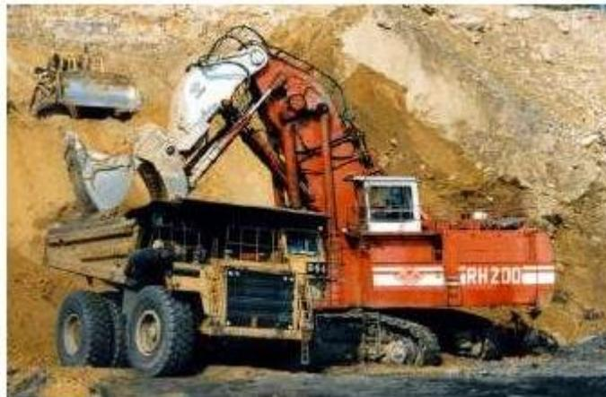
**Fig .III.1:**chargement d'une pelle hydraulique en butte
