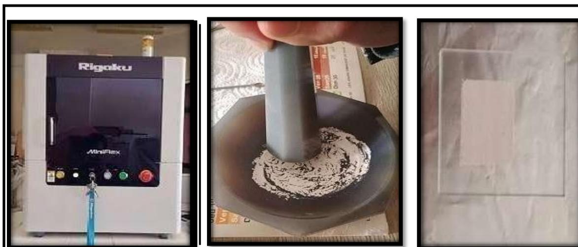
**Figure II.6.** Diffractomètre de rayons X de type« Rigaku Mini-flex »
