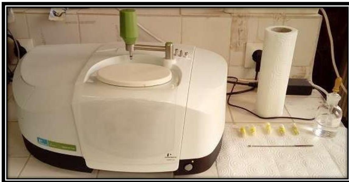
**Figure II.7.** Spectrophotomètre FTIR (*Laboratoire physico-chimique etcatalyse*)
