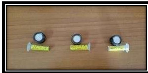
**Figure II.9.** Poudres  $Y_2O_3 :Sm^{3+}$  dans les portes d'échantillons d'un spectromètre de photoluminescence.
