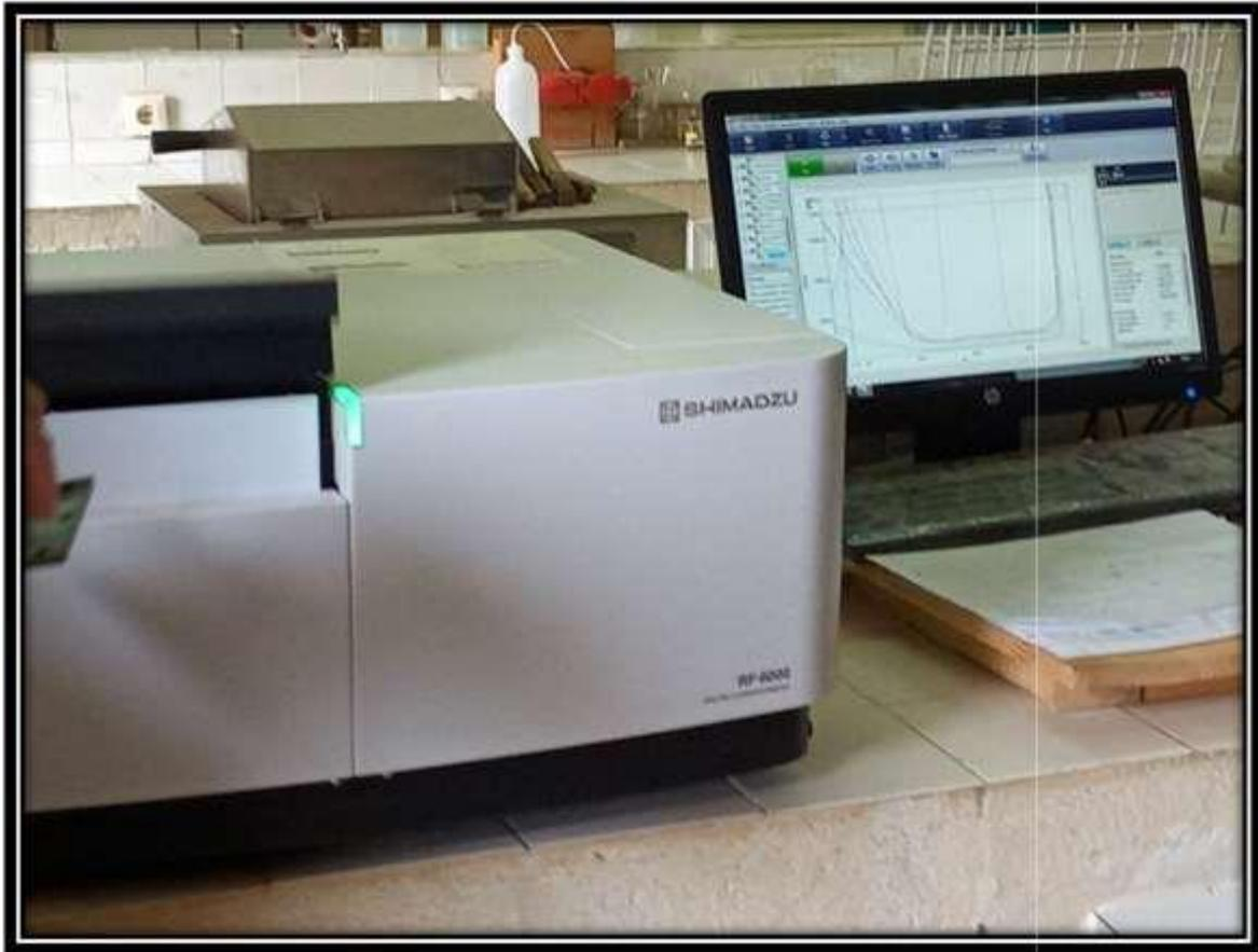
**Figure II.8.** Spectromètre de luminescence SHIMADZU RF 6000.
