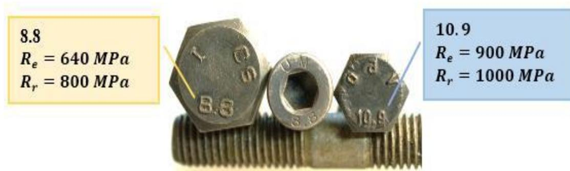
Figure II.23 : Indication de la classe de qualité d'une vis
