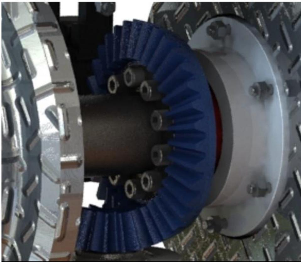
**Figure III.12:** répartition des boulons sur l'arbre et la couronne
