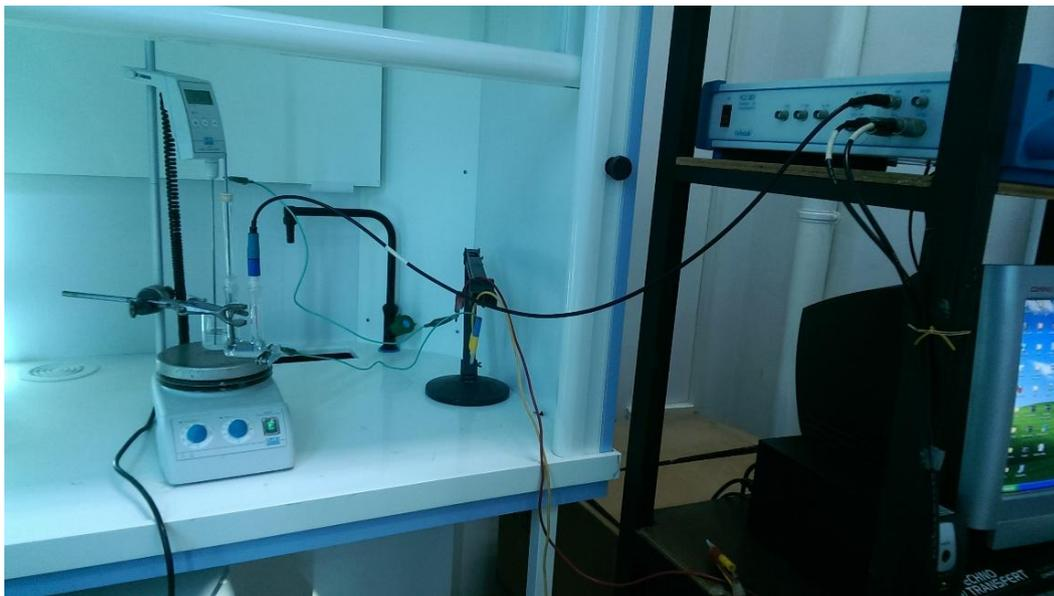
*Figure II.6 : Cellule électrochimique utilisée pour l'évaluation de la corrosion des substrats recouverts de poudre de verre bioactif.*
