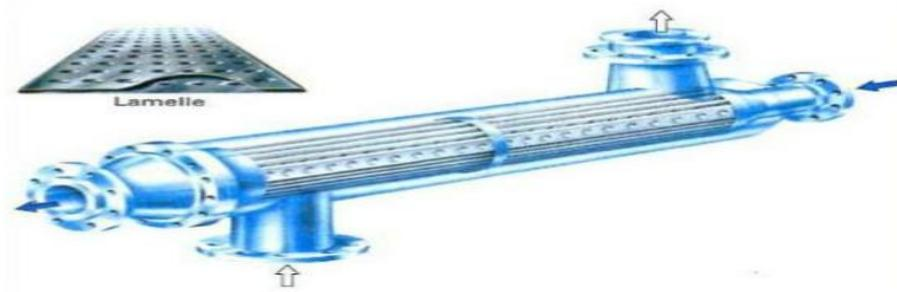
**Figure I.10 : Echangeur lamellaire (document ALFA LAVAL) [1]**
