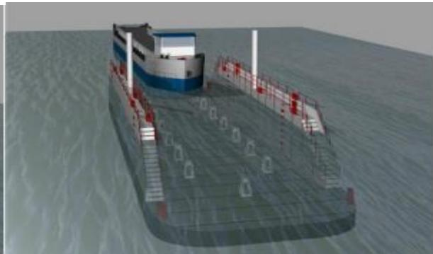
**Figure I.5 :** Dock en cours de ballastage et d'enfoncement.
