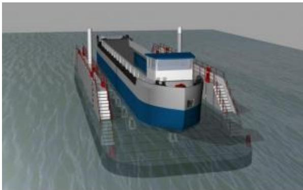
**Figure I.6 :** Entrée du bateau sur Dock : positionnement et arrimage.
