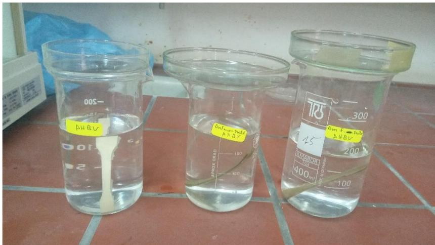
**Figure II.8:** Tests d'absorption d'eau.
