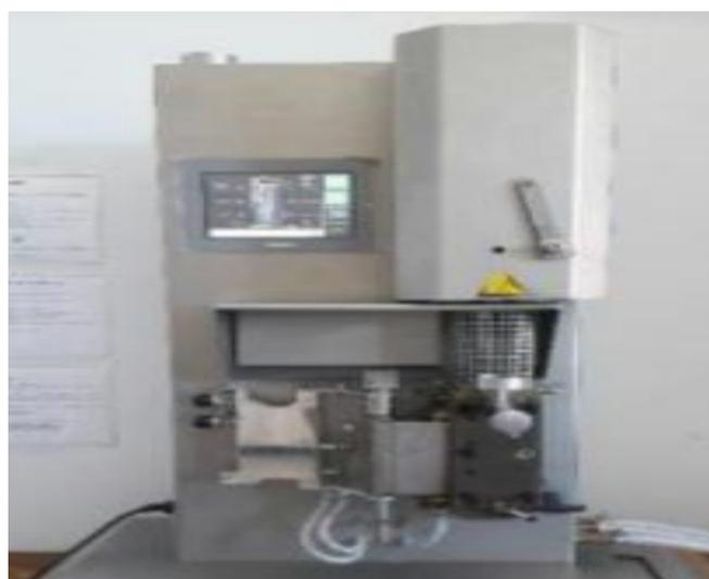
**Figure II.5** : Mini-extrudeuse bi-vis DSM Xplor.
