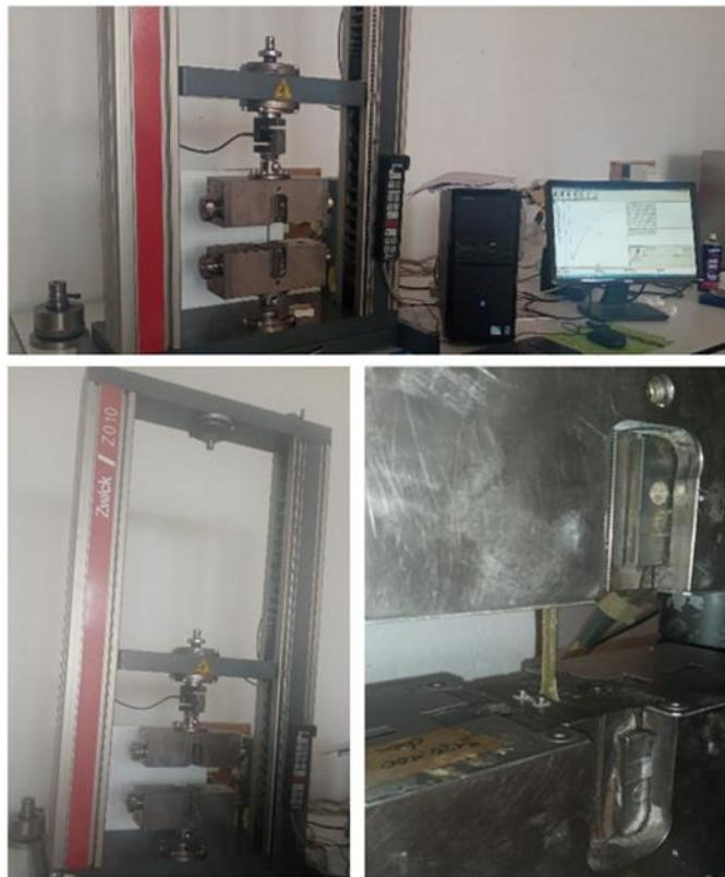
**Figure II.10:** Machine de traction mécanique.
