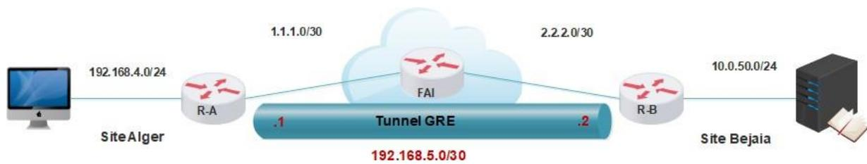
Figure II.12 – Principe du tunnel GRE
