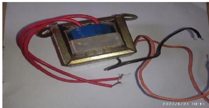
**Figure (II.15) :** photo du transformateur utilisé 12V/600mA.
