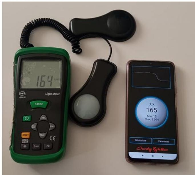
**Figure 3.15** : une comparaison entre l’application et l’instrument luxmètre
