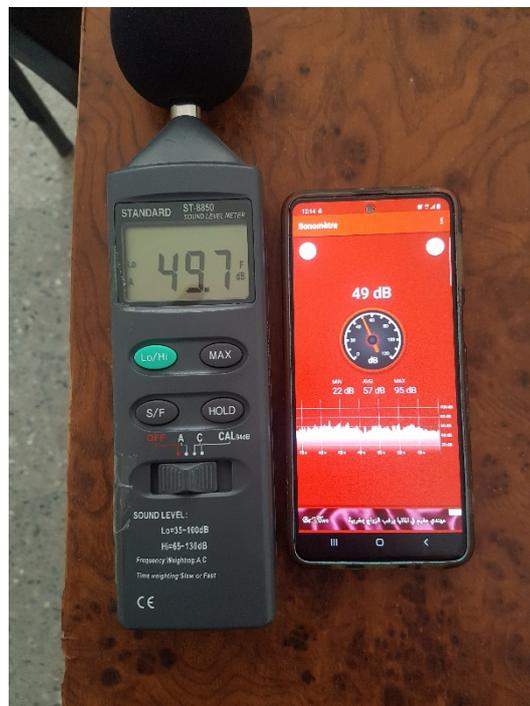
**Figure III-7 :** Comparaison entre sonomètre et application Android « sonomètre »
