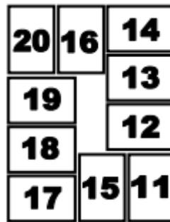
Figure II. 14: Formation de la 2eme couche de cartons de la ligne2.
