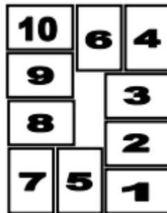
Figure II. 13: Formation de la 1ere couche de cartons de la ligne2.
