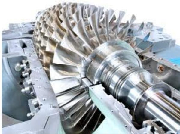
Figure I.12: compresseur axial
