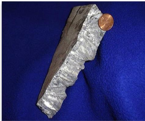
Figure I-11: Tranche de zinc à côté d'une pièce d'un pence (Zn recouvert de cuivre).
