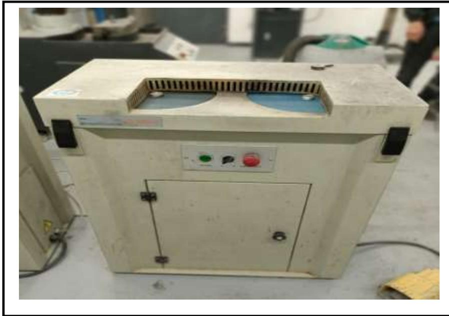
**Figure III.13 :** Polisseuse automatique.
