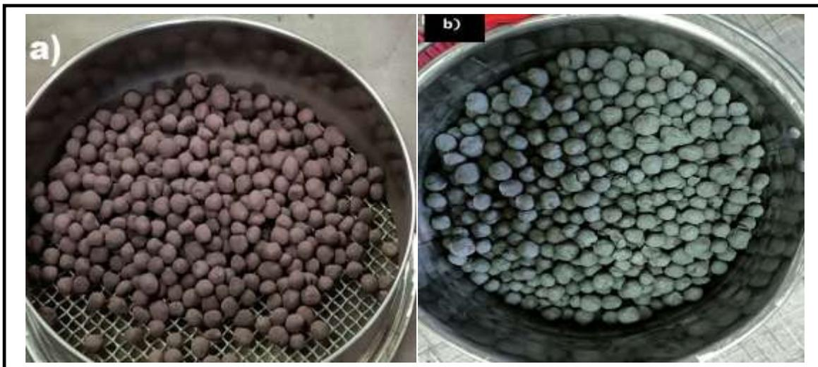
**Figure III.1** : Pellets d'oxyde de fer, (a) avant réduction, (b) après réduction.
