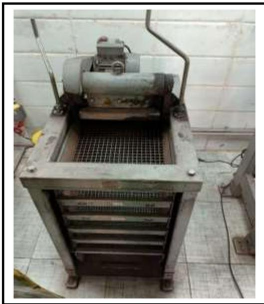
**Figure III.3 :** Tamiseur automatique.
