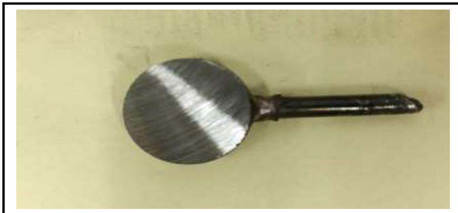
**Figure III.14 :** L'état de surface d'échantillon après polissage.
