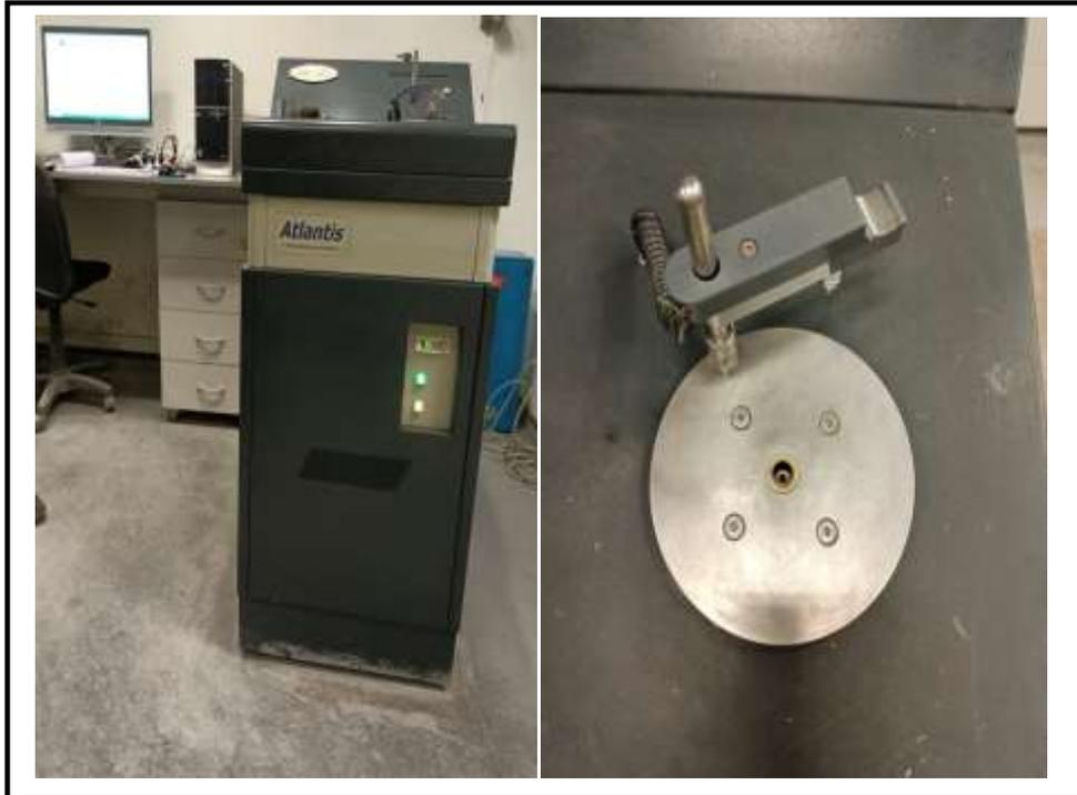
**Figure III.15 :** Spectromètre d'émissions optique.
