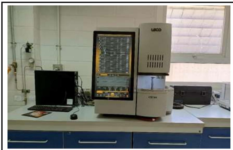
**Figure III.9** : Analyseur LECO CS744.
