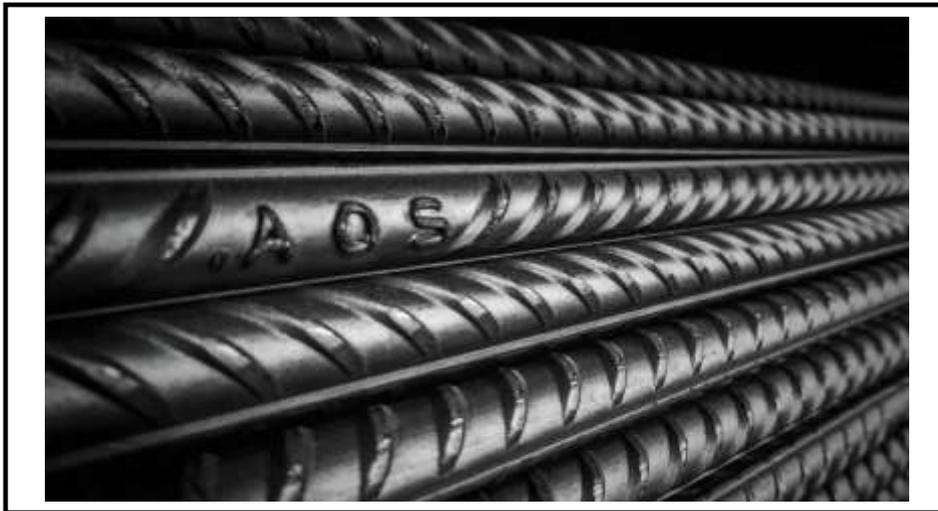
**Figure I.11 :** Rond à béton
