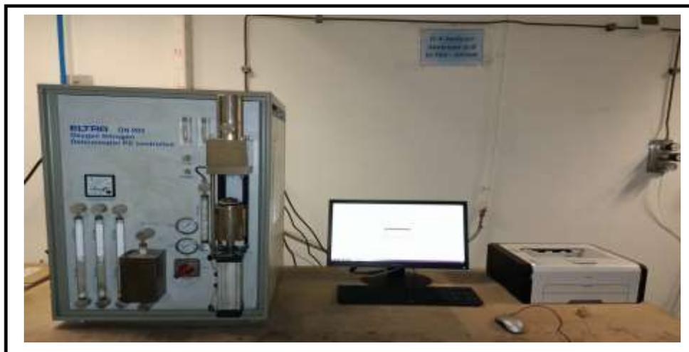
**Figure III.19** : L'analyseur ELTRA ON-900.
