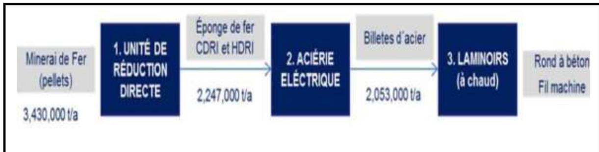
**Figure II.2 :** Étapes de la transformation sidérurgique (phase) [1]. **t/a** : tonnes par an
