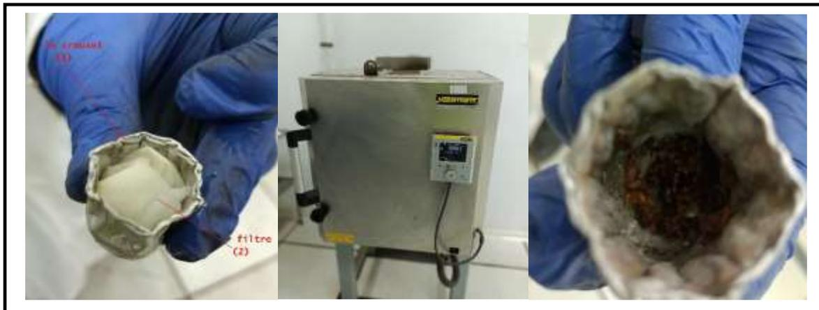
**Figure III.11 :** (a) : le creuset avant traitement, (b) : le four à moufle, (c) : le creuset après traitement.
